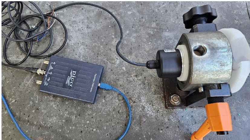
Σχήμα 3.2: Πειραματική διάταξη για τη μέτρηση τριβής απόσβεσης του δίσκου.
