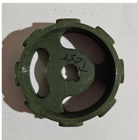
Σχήμα 4.4: Δίσκος τύλιξης των πηνίων.
