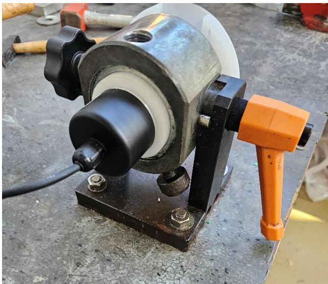
Σχήμα 3.11: Αριστερή όψη της πειραματικής διάταξης για τη μέτρηση τριβής απόσβεσης φυσικού εκκρεμούς.
