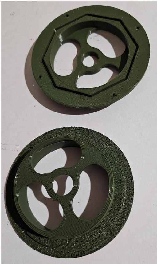
Σχήμα 4.6: Δεξιός (πάνω) και αριστερός (κάτω) δίσκος του ρότορα.
