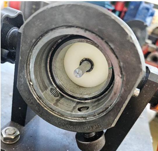
Σχήμα 3.13: Ο άξονας και το ρουλεμάν της πειραματικής διάταξης.
