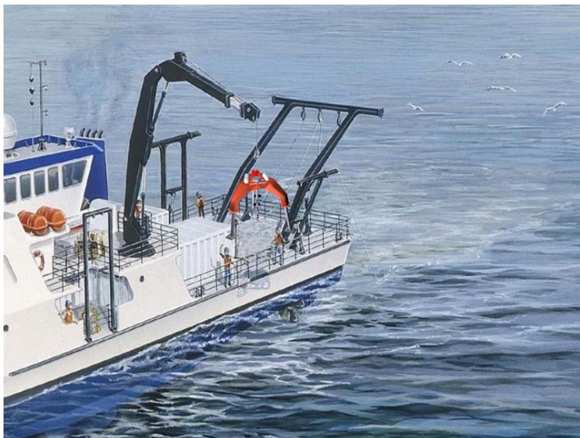
Εικ.38 Αρχή της ανάπτυξης με τη βοήθεια γερανού από το ωκεανογραφικό σκάφος
