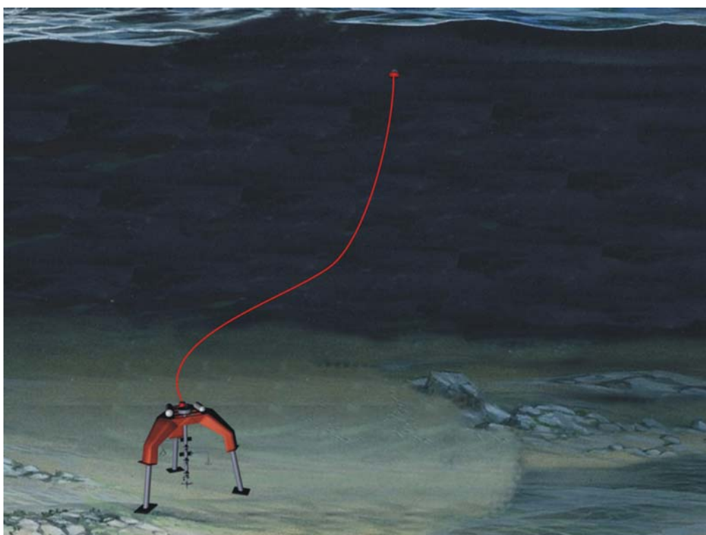
Εικ.44 Απελευθέρωση της σηματοδούρας και άνοδος προς την επιφάνεια
