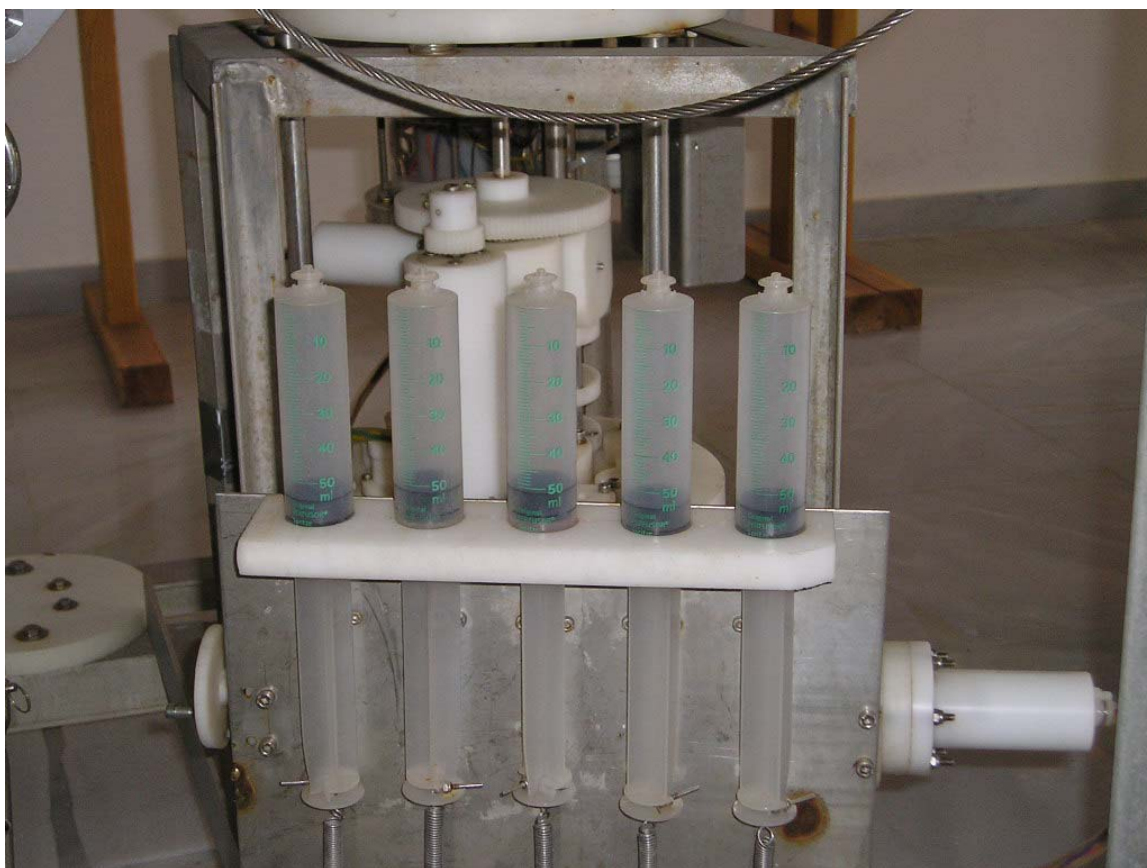
Εικ. 15 Οι πλαστικές σύριγγες που χρησιμοποιούνται για την εξαγωγή του νερού από το δείγμα.
