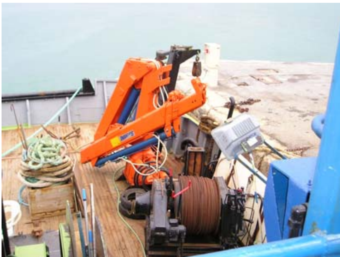
Εικ.18 Εικόνα από το κατάστρωμα του ΦΙΛΙΑ. Φαίνεται ο γερανός που χρησιμοποιείται για την καθέλκυση της ακάτου.
