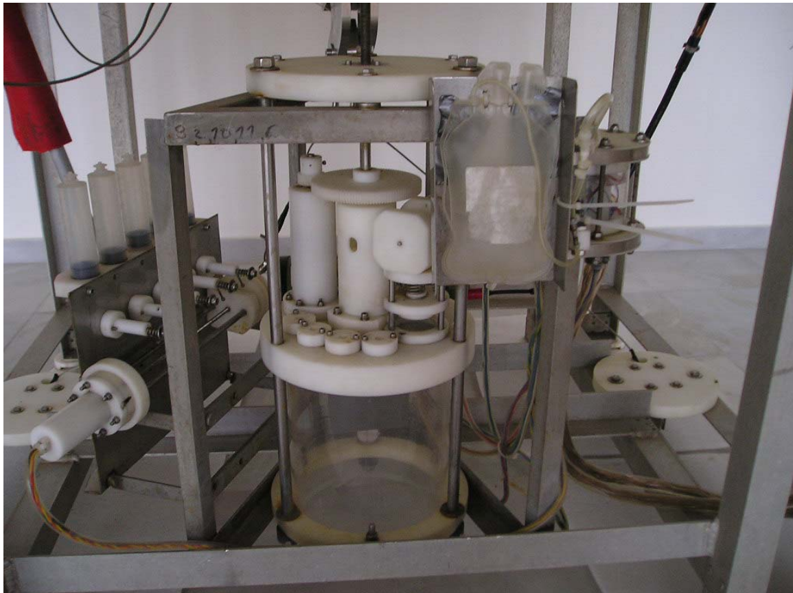
Εικ. 14 Ο βενθικός θάλαμος και ο κινητήριος μηχανισμός.
