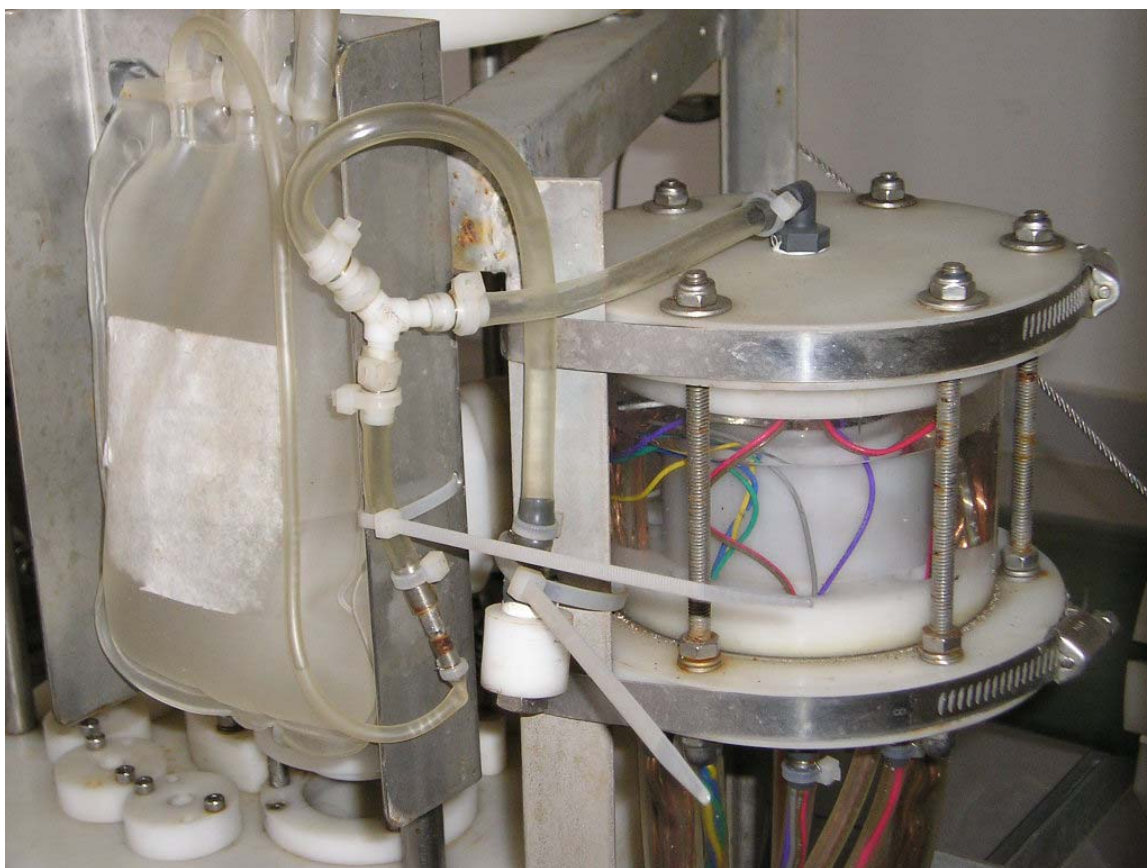
Εικ.16 Το ειδικό υγρό, που βρίσκεται σε όλα τα δοχεία και τα καλώδια του συστήματος για προστασία από την υδροστατική πίεση
