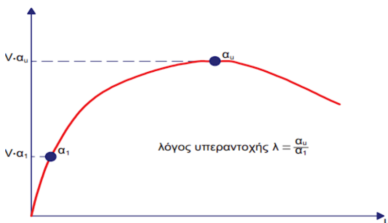
Εικόνα 1 Καμπύλη αντίστασης κατασκευής
