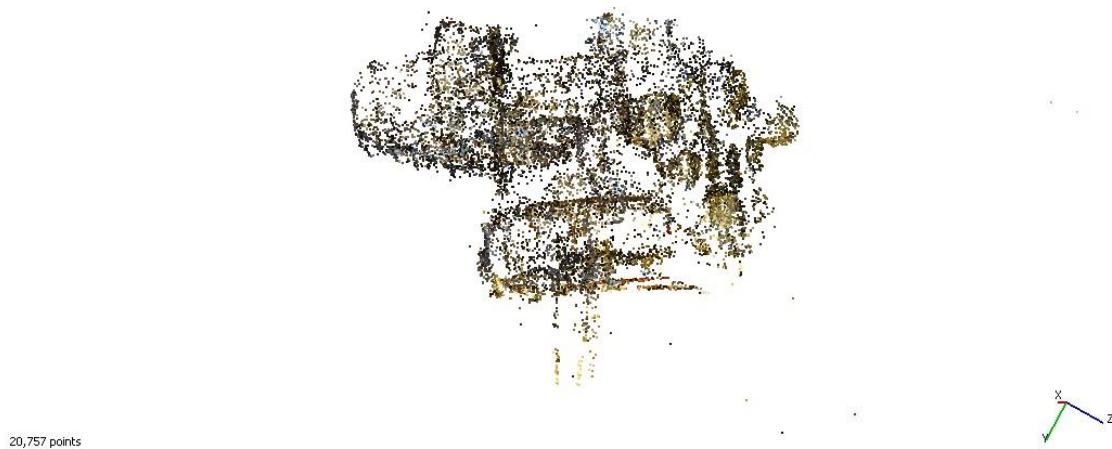
Εικ. 5. Φωτογραφία του μοντέλου μετά το στάδιο του Align (Tie points – Sparse point cloud)
