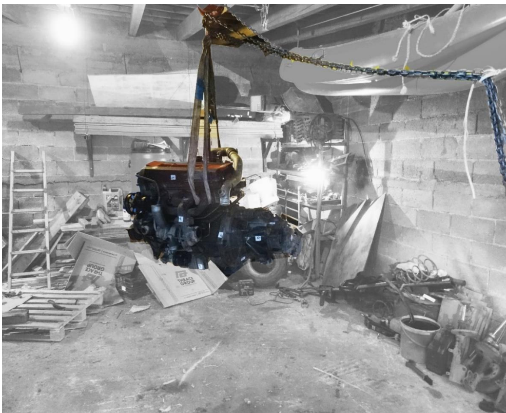
Εικ. 1. Τοποθέτηση επαρκούς φωτισμού περιμετρικά του αντικειμένου και ανάρτηση αυτού με ιμάντες
