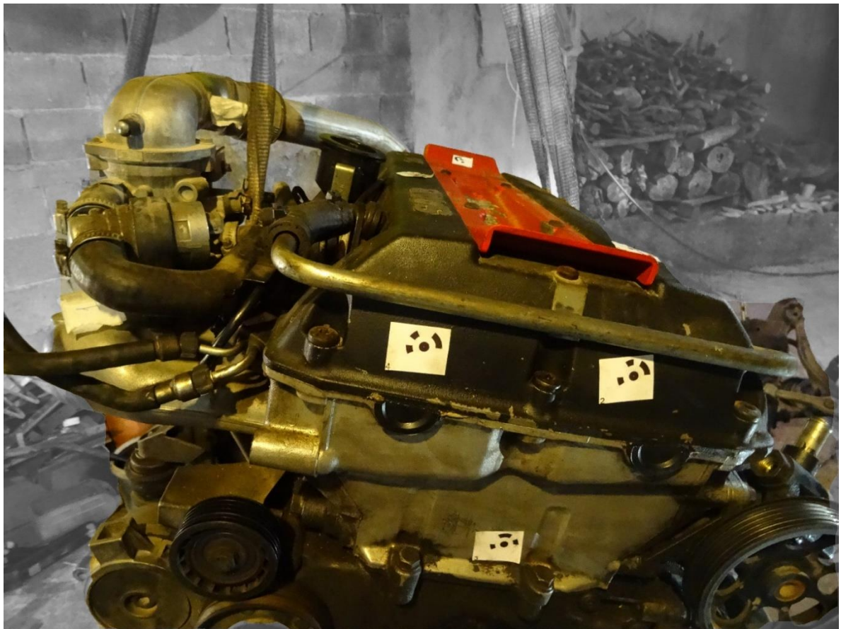
Εικ. 3. Τοποθέτηση αριθμημένων στόχων στην κατάλληλη διάταξη.
