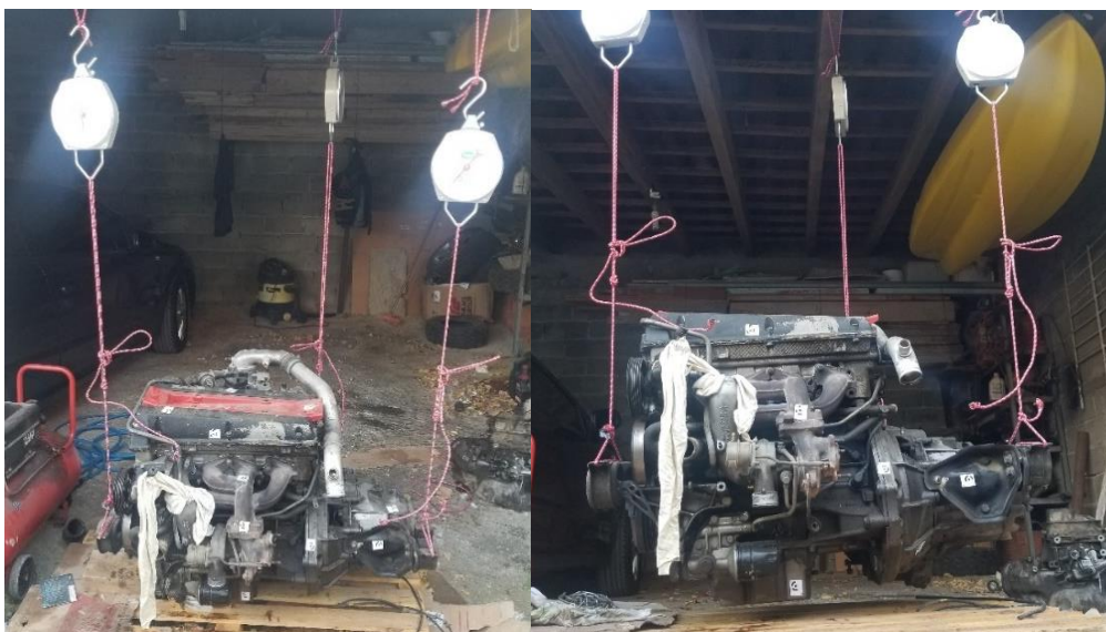
Εικ. 33. Ανάλυση δυνάμεων βάρους στις 3 βάσεις
