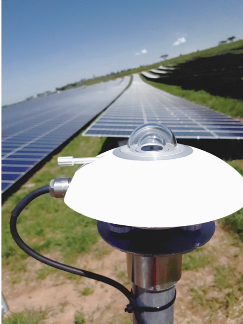
Figure 18: Πυρανόμετρο σε εγκατάσταση
