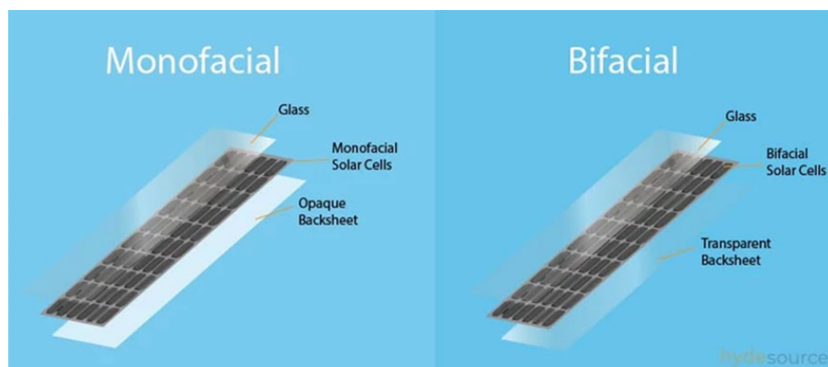
Figure 13: Σύγκριση πλαισίων μονής και διπλής όψης
