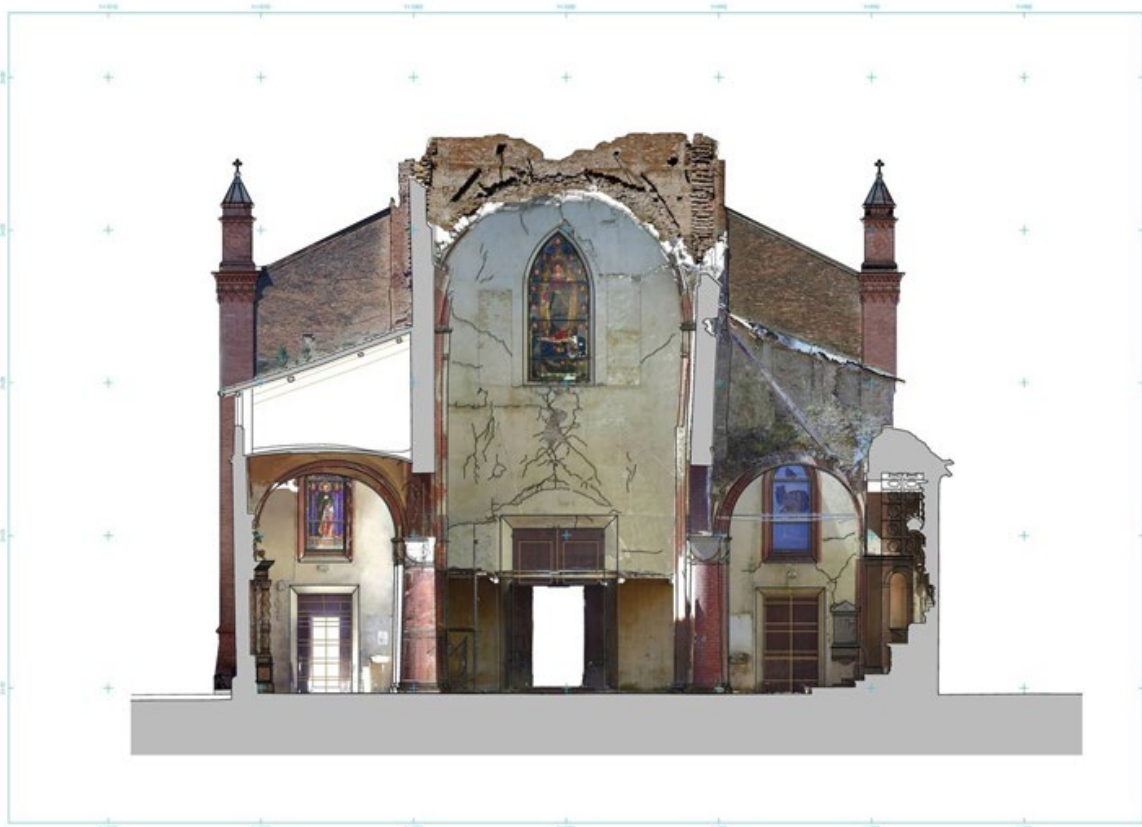
Εικόνα 30: Εγκάρσια τομή του ναού με χρήση ορθοφωτογραφίας από 3D Laser Scanner στην οποία εμφανίζεται η απόκλιση των 35 εκ. από την κατακόρυφο της δεξιάς τοιχοποιίας του κεντρικού κλίτους.
