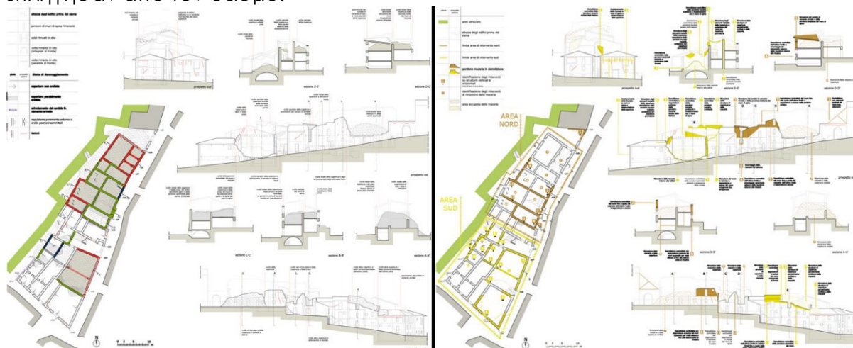
Εικόνα 26: Δεξιά. Χάρτης της υφιστάμενης κατάστασης του συμπλέγματος κτηρίων στον οποίο αποτυπώνεται η έκταση των καταρρεύσεων, η θέση των ερειπίων και οι ρωγμές στα σωζόμενα κτήρια. Αριστερά. Χάρτης με προτάσεις αποκατάστασης της ίδιας δομής.
