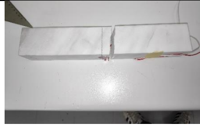
Κάτω έδρα πρισματικού δοκιμίου μετά την κάμψη
