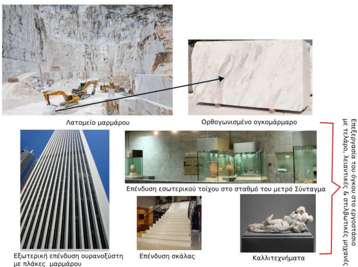
Εικ. 2.3. «Διαδρομή» του μαρμάρου από το λατομείο στην μοντέρνα κατασκευή αλλά και σε μνημειακές εφαρμογές (αναστυλώσεις μνημείων, γλυπτική κ.λπ).
