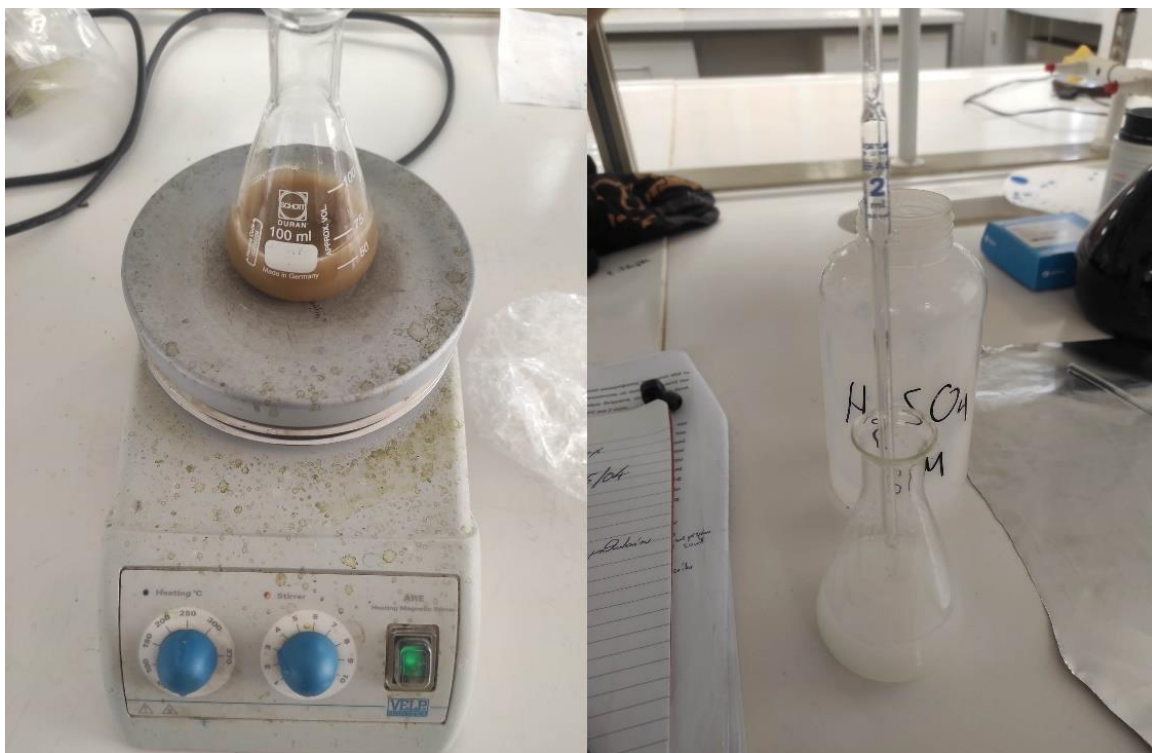
Εικόνα 33 Ανάδευση δείγματος Imerys B5 και προσθήκη H_2SO_4 5M.
