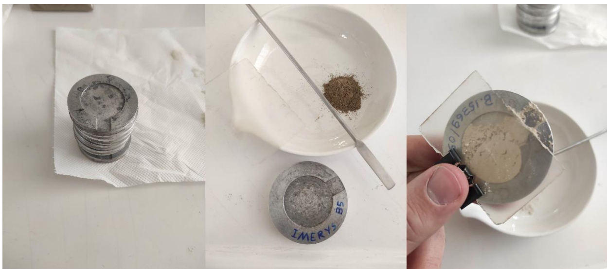
Εικόνα 14 Διαδικασία προετοιμασίας δείγματος για XRD
