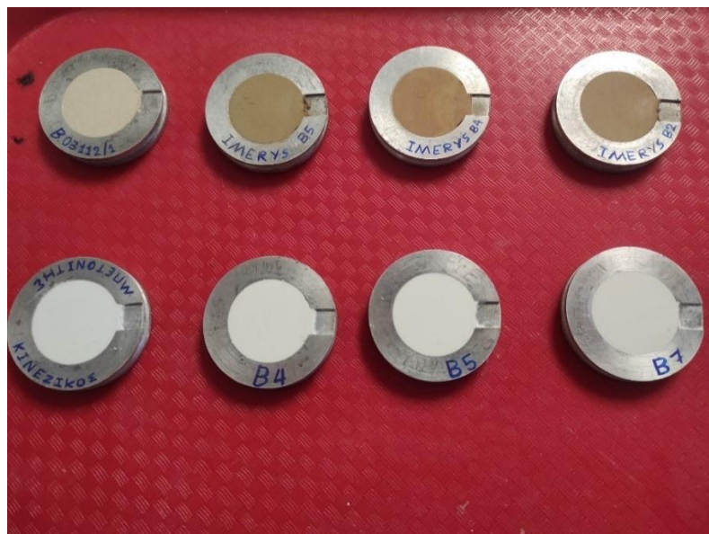
Εικόνα 15 Δείγματα έτοιμα για XRD
