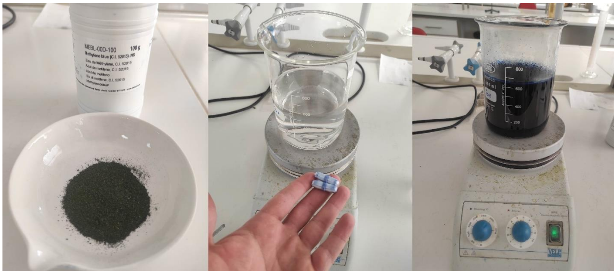
Εικόνα 31 Διαδικασία παρασκευής διαλύματος κυανού του μεθυλενίου.
