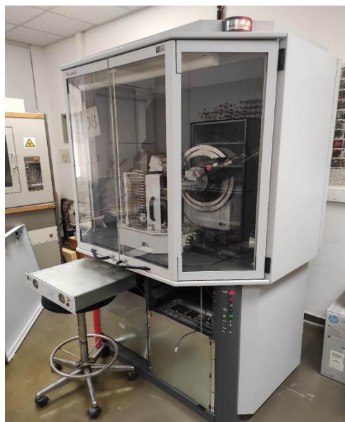
Εικόνα 16 Περιθλασίμετρο ακτίνων-X (XRD) Bruker AXSD8 ADVANCE
