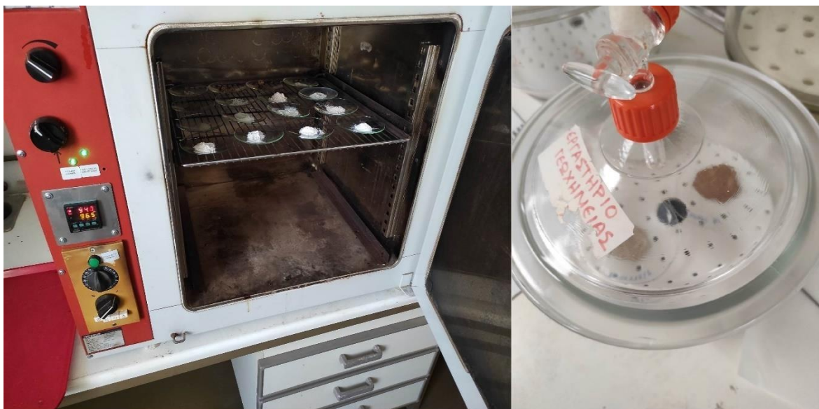
Εικόνα 24 Δείγματα στον φούρνο στους 105 °C και μεταφορά με ξηραντήρα
