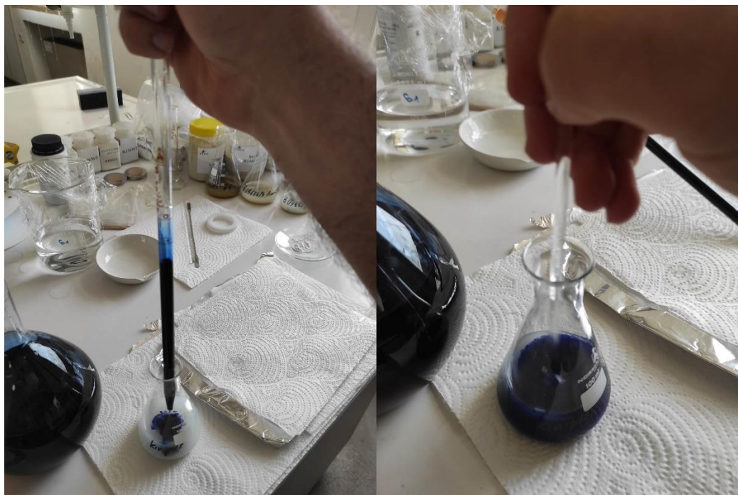
Εικόνα 34 Προσθήκη σταγόνων του κυανού του μεθυλενίου και ανάδευση του αιωρήματος με υάλινη ράβδο.
