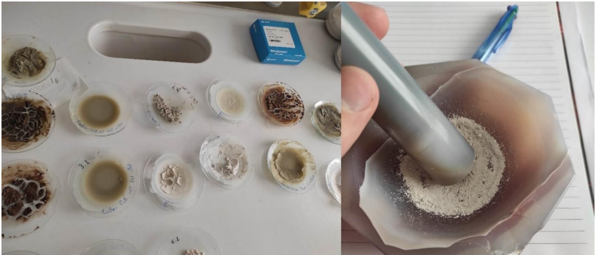
Εικόνα 26 Δείγματα μετά την ξήρανση 24 ωρών και λειοτρίβηση αυτών σε γουδί από αχάτη.
