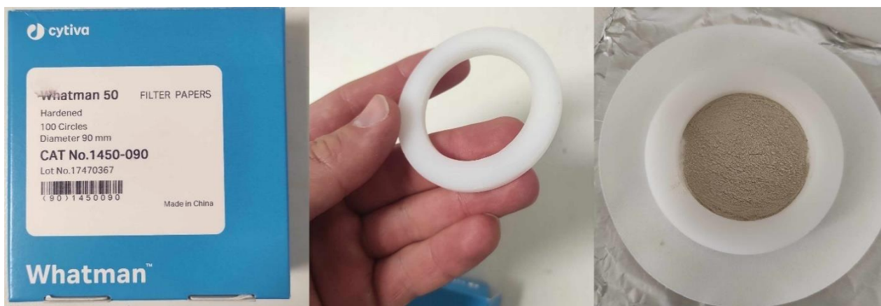
Εικόνα 27 Ηθμός Whatman 50, κυκλικός δακτύλιος και δείγμα στον ηθμό με κυκλικό δακτύλιο.
