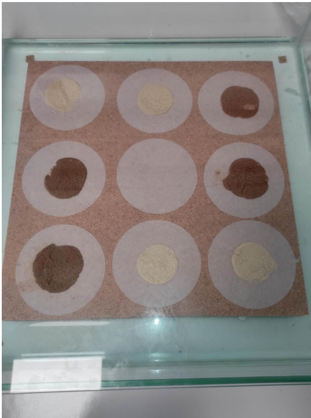
Εικόνα 28 Δοκιμή κεραμικής πλάκας. Δύο ηθμοί για κάθε δείγμα και ένα τυφλό στο κέντρο της πλάκας.
