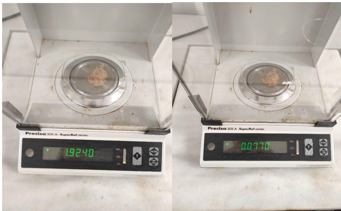
Εικόνα 25 Δείγμα IMERYS B4 1,9240 gr και προσθήκη 0,08 gr \text{Na}_2\text{CO}_3
