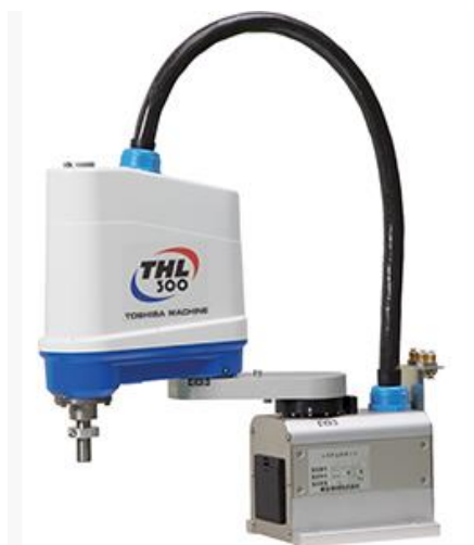
Εικόνα 2.4 Ρομπότ Scara, μοντέλο THL 300 [7]
