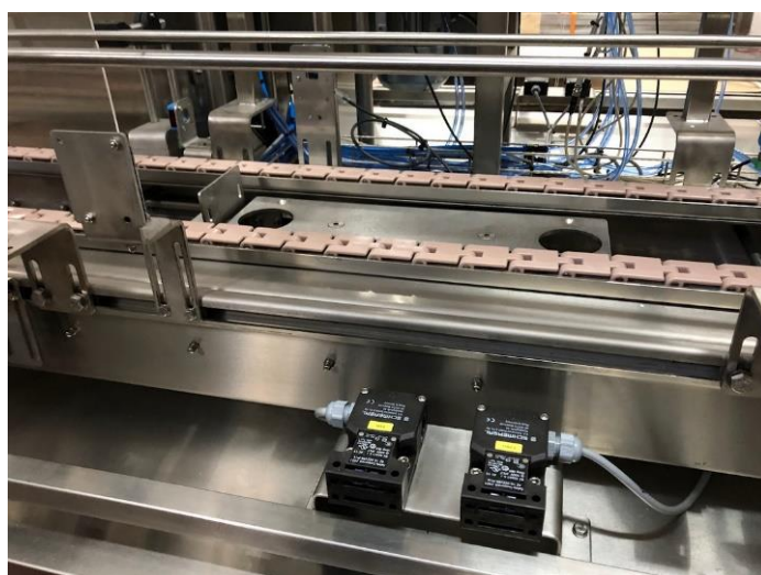
Εικόνα 3.3 Αισθητήρες Εγγύτητας (Proximity Sensors)
