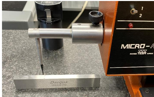
Εικόνα 3.1.14: Μέτρηση της επιπεδότητας του πρότυπου πλακιδίου με υψομετρικό όργανο.
