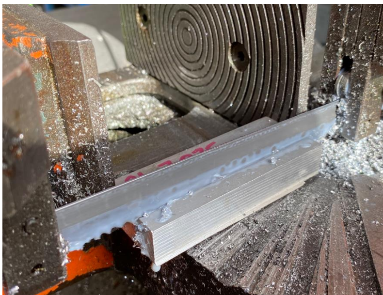
Εικόνα 2.3.2: Φωτογραφία κατά την κοπή της πρώτης ύλης στο ηλεκτρικό πριόνι.
