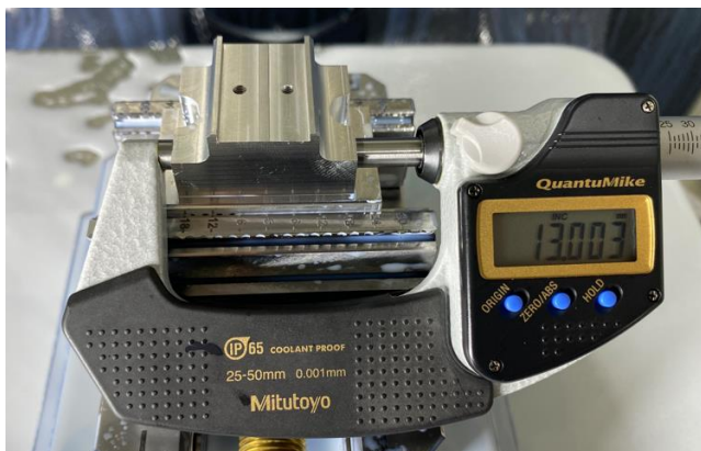
Εικόνα 3.3.12: Μέτρηση του συνολικού πλάτους του τεμαχίου με μικρόμετρο 25–50 mm ( 25,000 + 13,003 = 38,003 mm).
