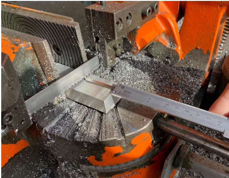
Εικόνα 2.3.1: Εύρεση σημείου κοπής της πρώτης ύλης για ένα τεμάχιο, με χρήση παχυμέτρου.
