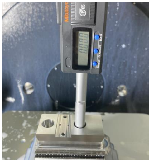
Εικόνα 3.4.11: Μέτρηση διαμέτρου οπής ακριβείας με αντιστάθμιση -0,0165 mm.
