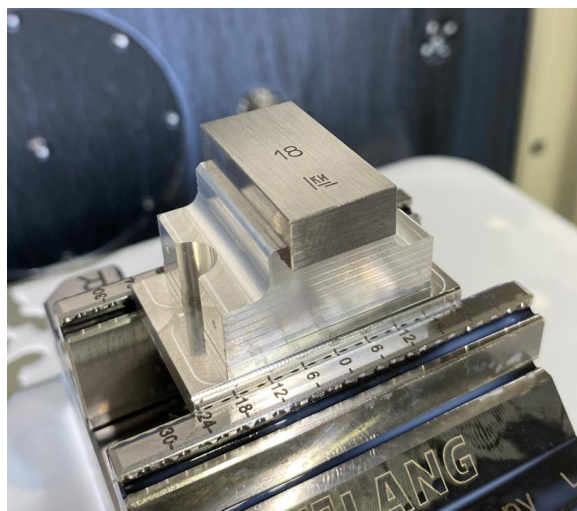
Εικόνα 3.3.11: Έλεγχος της εσοχής με τη χρήση του πρότυπου πλακιδίου.
