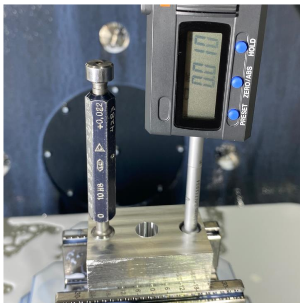
Εικόνα 3.2.11: Έλεγχος της οπής με ελεγκτήρα Go και μέτρηση τελικής διάστασης με μικρόμετρο.
