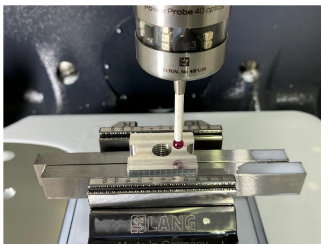
Εικόνα 3.2.19: Μηδενισμός των αξόνων X και Y μετά την αφαίρεση της πρώτης ύλης της πάνω επιφάνειας.
