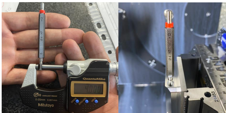
Εικόνα 3.4.14: Έλεγχος του ελεγκτήρα οπής για επαλήθευση της ακρίβειάς του (αριστερά) και έλεγχος οπών με τον ελεγκτήρα (δεξιά).
