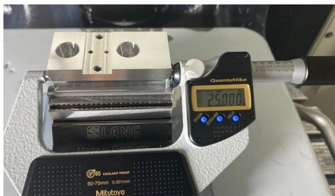
Εικόνα 3.4.13: Μέτρηση του συνολικού μήκους: 25,000 + 50,000 = 75,000 mm.
