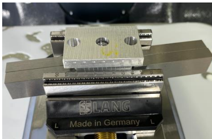
Εικόνα 3.2.17: Τα πλακίδια και το τεμάχιο τοποθετημένα στο σύστημα συγκράτησης.
