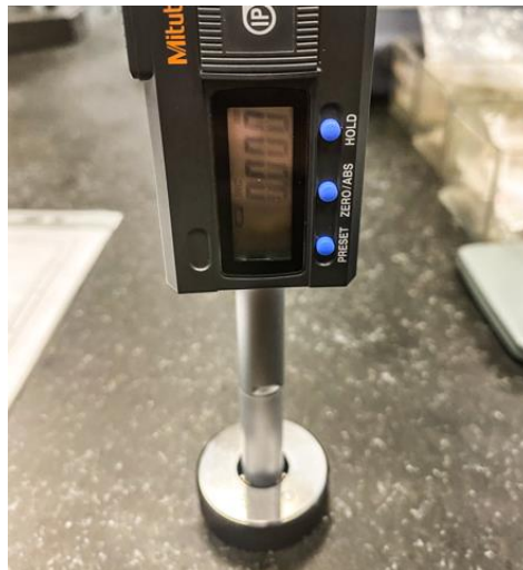
Εικόνα 3.4.10: Καλιμπράρισμα – Μηδενισμός του μικρομέτρου οπής στα Ø14 mm.
