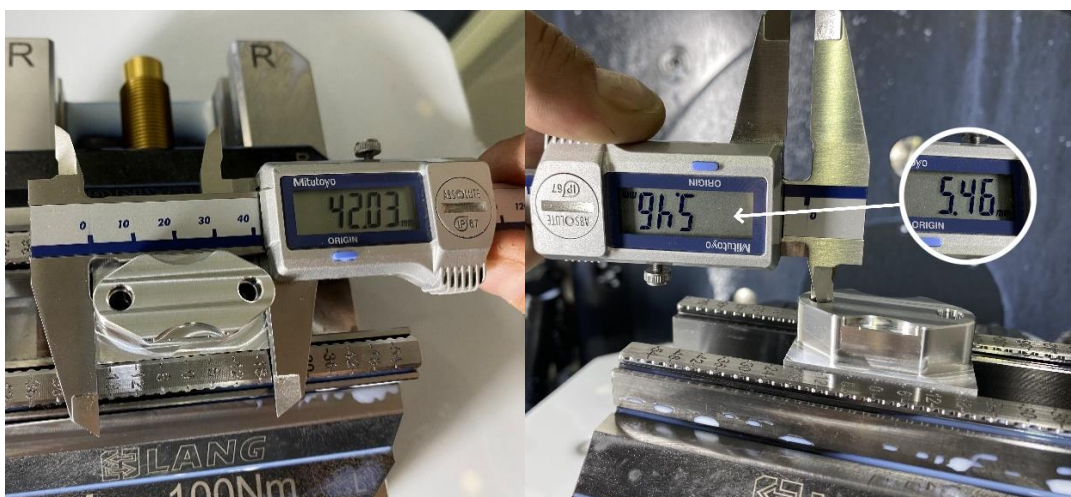
Εικόνα 3.1.9: Μέτρηση του συνολικού μήκους και των διαμέτρων των οπών.
