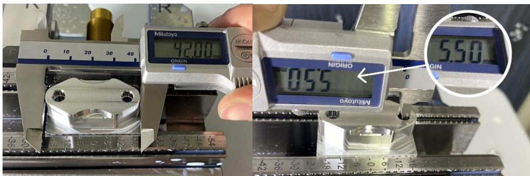
Εικόνα 3.1.10: Μέτρηση του συνολικού μήκους και των διαμέτρων των οπών μετά τις αλλαγές των αντισταθμίσεων.
