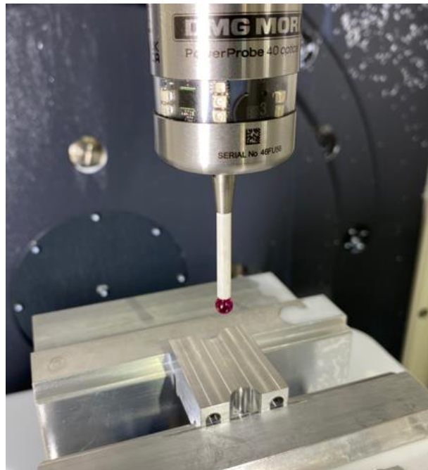
Εικόνα 3.3.18: Μέτρηση – Μηδενισμός των αξόνων XYZ με το touch probe.
