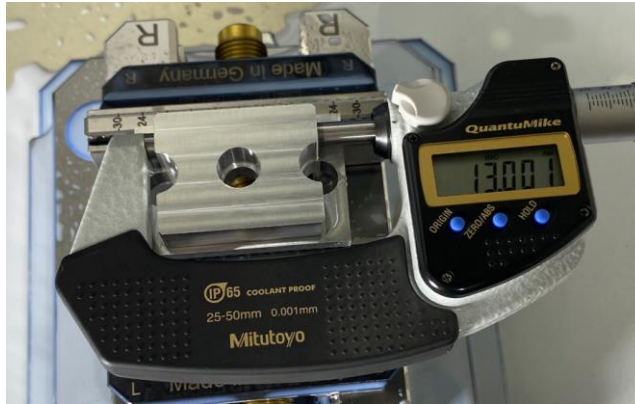
Εικόνα 3.2.12: Μέτρηση μήκους με μικρόμετρο εύρους 25 – 50 mm.
