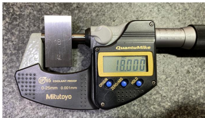
Εικόνα 3.3.10: Μέτρηση του πρότυπου πλακιδίου με μικρόμετρο για επαλήθευση της ακρίβειας της διάστασής του.
