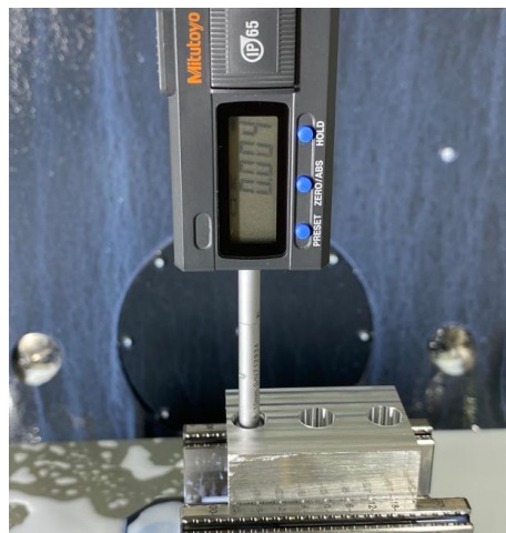
Εικόνα 3.2.10: Μέτρηση της οπής μετά την πρώτη αλλαγή στην αντιστάθμιση.
