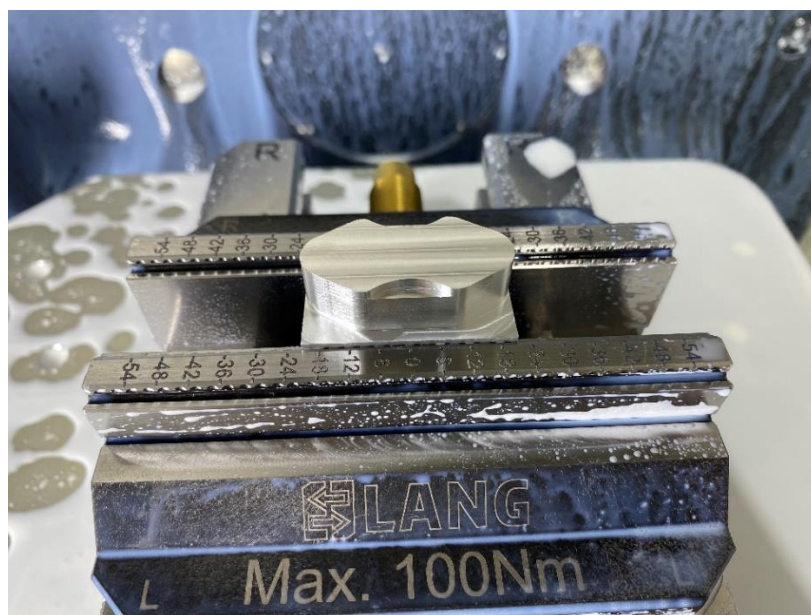
Εικόνα 3.1.7: Ξεχόνδρισμα μέσω του κοντυλιού T1 στην πάνω επιφάνεια και περιφερειακά της πρώτης ύλης.
