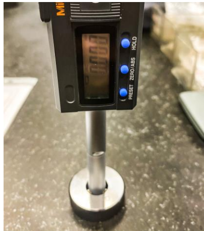
Εικόνα 3.2.9: Μηδενισμός μικρομέτρου οπής με καλίμπρα διαμέτρου 10mm.
