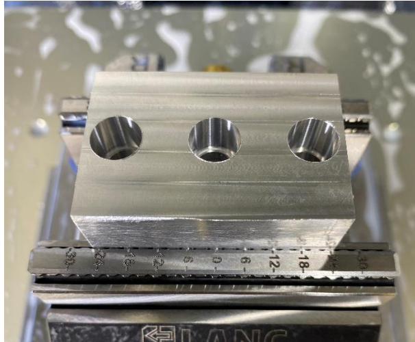
Εικόνα 3.2.8: Η γεωμετρία του τεμαχίου για να μετρηθούν οι διάμετροι ακριβείας.
