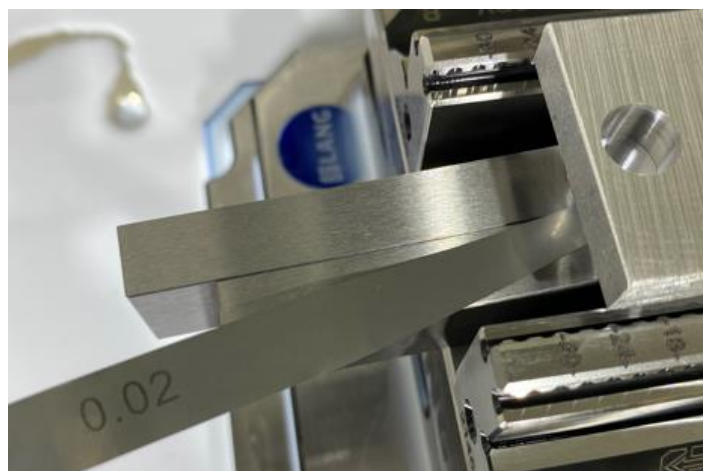
Εικόνα 3.2.18: Έλεγχος πλήρους επαφής πλακιδίου και τεμαχίου με φύλλερ 0,02 mm. Με αυτόν τον τρόπο θα επιτευχθεί η επιτεδότητα στο τελικό τεμάχιο.
