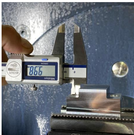
Εικόνα 3.3.8: Μέτρηση των διαμέτρων των οπών ακριβείας με παχύμετρο.
