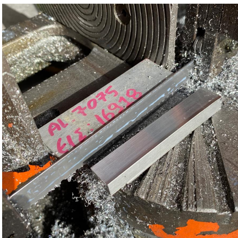
Εικόνα 2.3.3: Φωτογραφία μετά την κοπή της πρώτης ύλης στο ηλεκτρικό πριόνι.
