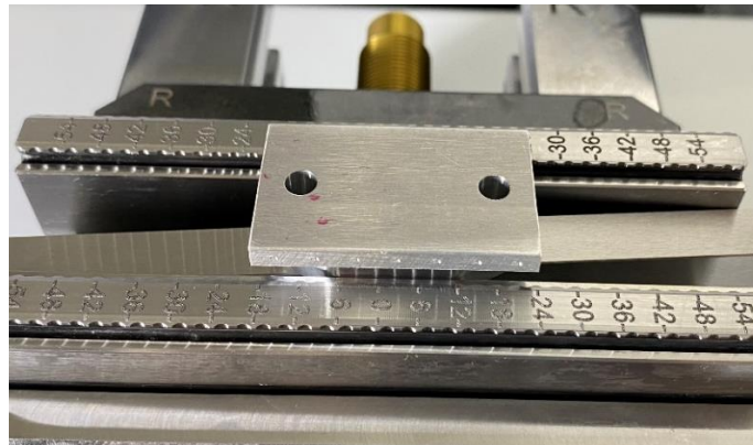
Εικόνα 3.1.15: Το τεμάχιο τοποθετημένο στη μέγγενη για την Β' Φάση.
