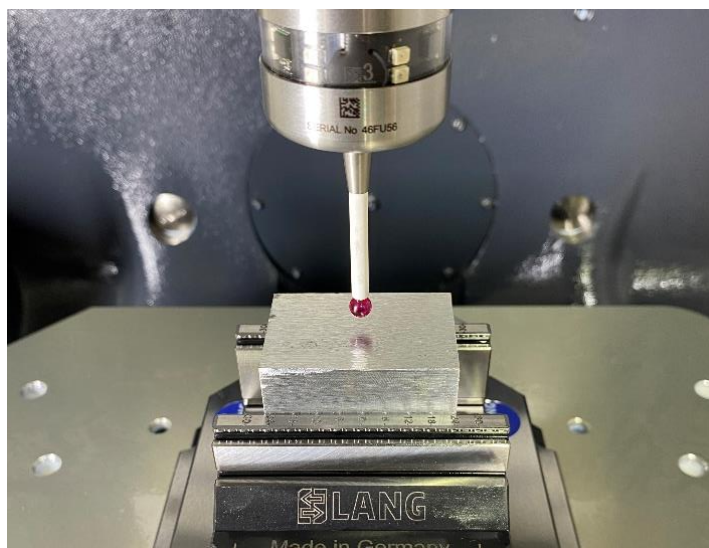
Εικόνα 3.2.7: Η πρώτη ύλη τοποθετημένη στη μέγγενη για την Α' Φάση.
