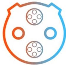
Σχήμα 19: Βύσμα φόρτισης τύπου CHAdeMO
