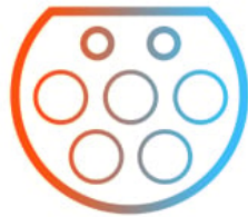
Σχήμα 18: Βύσμα φόρτισης τύπου 2
