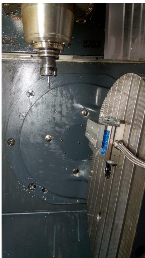
Σχήμα 4.2: Διάταξη κοπής.
