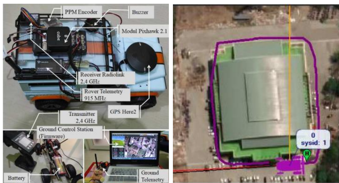
Εικόνα 20 Αριστερά: Η πειραματική διάταξη, Δεξιά: Η πορεία με την χρήση GNSS [32]
