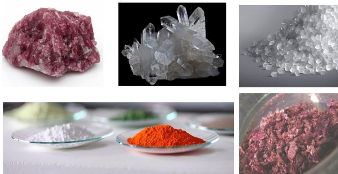
Εικόνα 1: Πιεζοηλεκτρικά υλικά (Κρύσταλλος τουρμαλίνης, χαλαζίας, πολυμερές PVDF, τρυγικό καλιονάτριο και τιτανικός ζirkονικός μόλυβδος).
