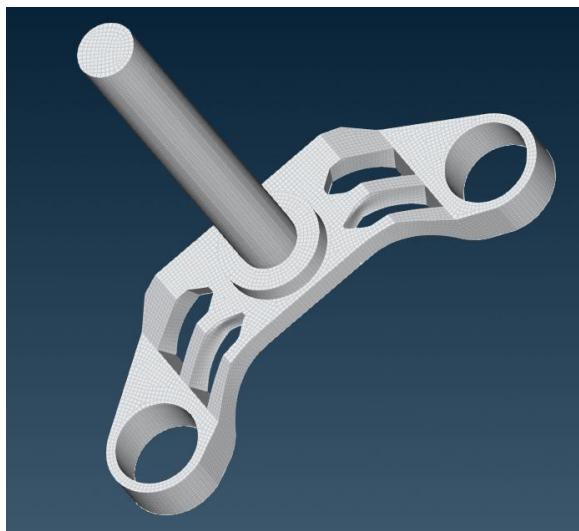
Εικόνα 73: Επανασχεδιασμός τριπλής σύνδεσης
