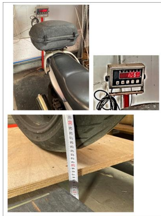
Εικόνα 36: Ανύψωση εμπρός τροχού στα 180 mm όσο ο πίσω πατάει στη ζυγαριά
