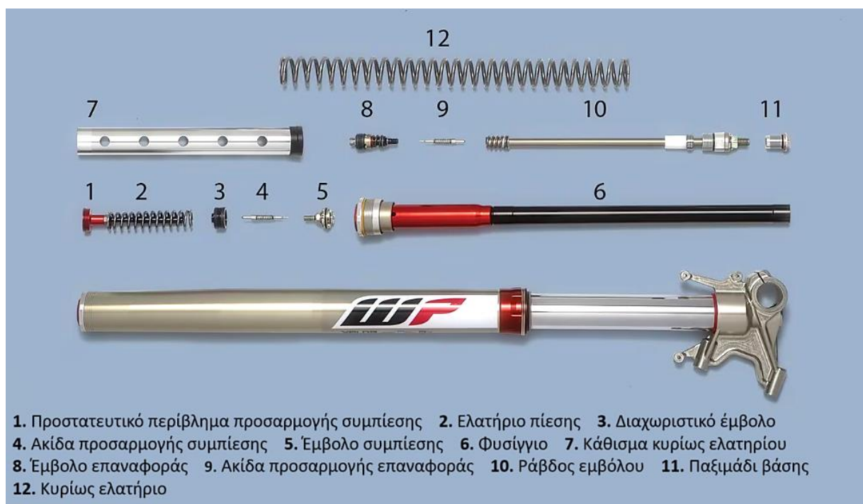
Εικόνα 27: Εξαρτήματα του τηλεσκοπικού πιρουνιού
