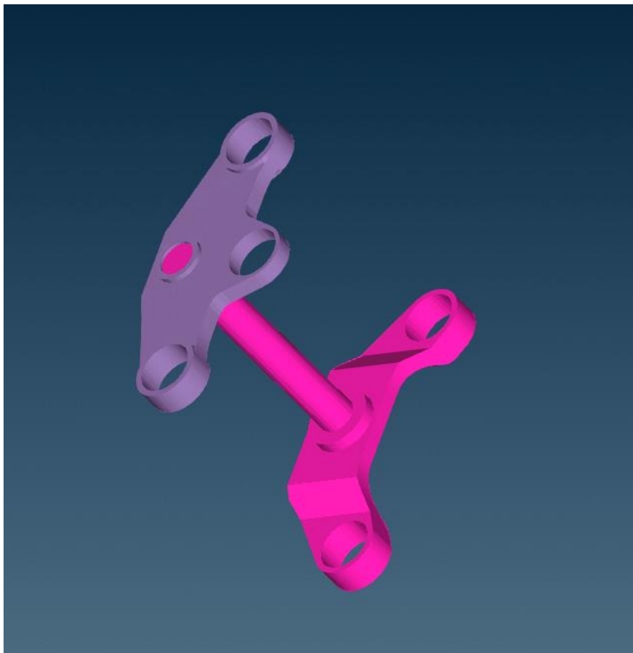
Εικόνα 54: Η τιμονόπλακα (πάνω) και η τριπλή σύνδεση (κάτω)
