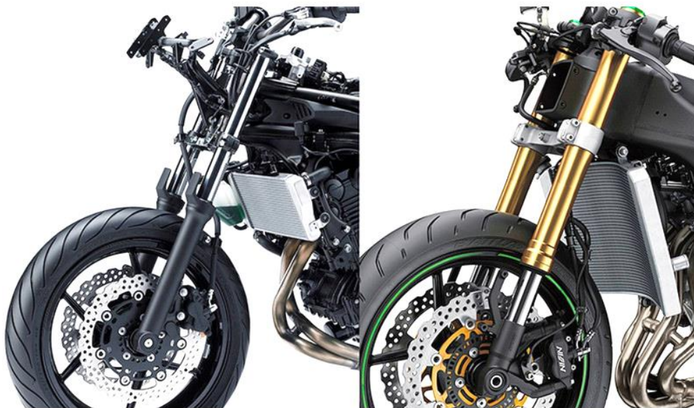
Εικόνα 18: Συμβατική (αριστερά) και αντεστραμμένη (δεξιά) εκδοχή του τηλεσκοπικού πιρουνιού (πηγή: topgearmag.in )
