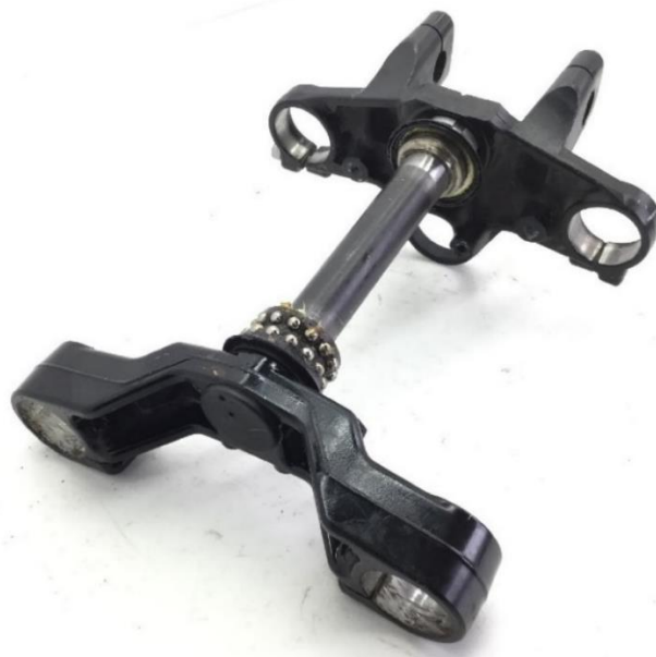
Εικόνα 26: Σύστημα τριπλής σύνδεσης (πάνω διακρίνεται η τιμονόπλακα με τις δύο υποδοχές του τιμονιού)
