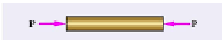
Εικόνα 2. Καταπόνηση ράβδου σε θλίψη από την εφαρμογή δύο δυνάμεων προς το κέντρο της.
