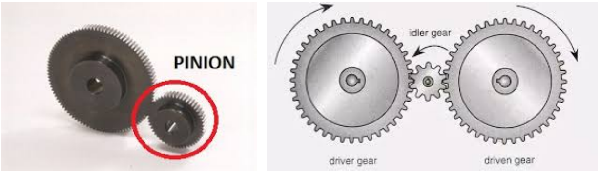
Εικόνα 7. Επίδειξη του pinion gear (αριστερά) και του idler gear (δεξιά).
