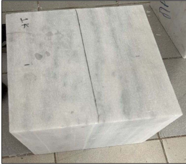
Εικόνα 2.2: Μέτρηση του ογκομαρμάρου ώστε να κοπεί για να μπορέσει να χωρέσει στον πυρηνολήπτη.
