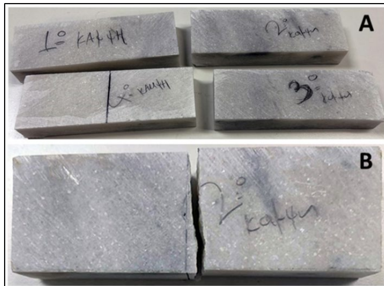
Εικόνα 3.18: (Α) Τα δείγματα κάμψεως πριν τη θραύση τους (ενδεικτικά με μπλε γραμμή συμβολίζεται ο άξονας φόρτισης) και (Β) η θραύση με ελαφριά κλίση του δοκιμίου K1-2.
