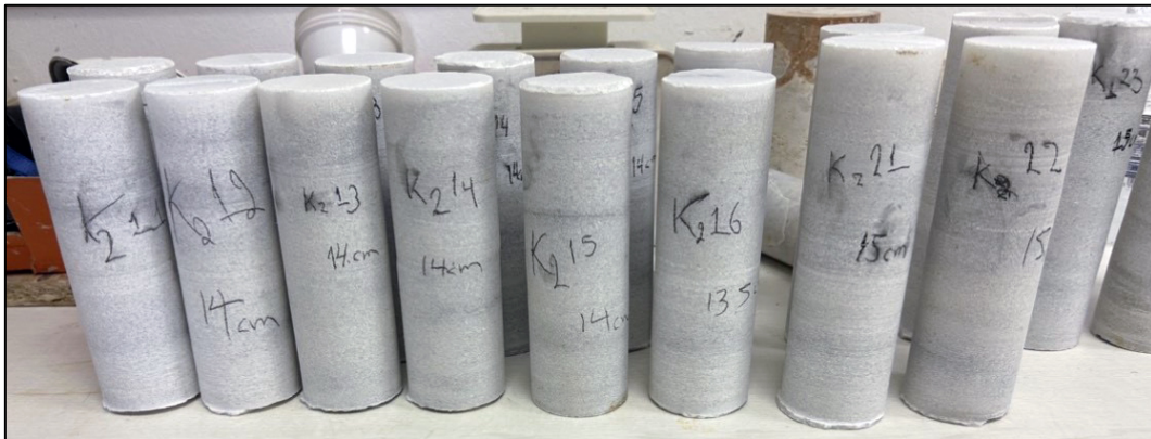
Εικόνα 3.11: Κυλινδρικά δοκίμια από τα υπό μελέτη ογκοτεμάχια K1 και K2 από το λατομείο της Π.Ε. Καβάλας.
