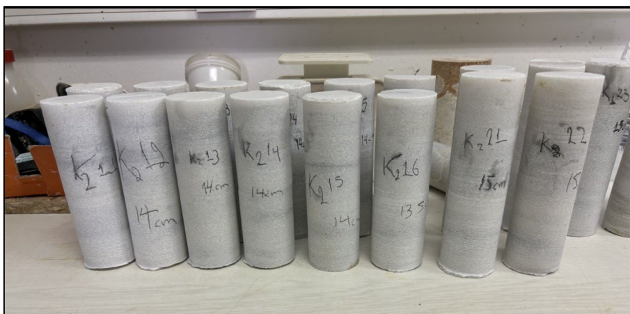
Εικόνα 2.4: Τα δοκίμια μετά τη λήψη τους και πριν το κόψιμό τους, ανάλογα με τις ανάγκες του κάθε πειράματος.
