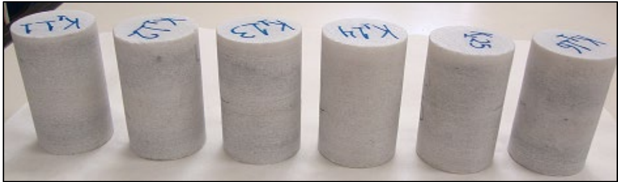
Εικόνα 2.6: Χαρακτηριστικά κυλινδρικά δοκίμια, που χρησιμοποιήθηκαν στις εργαστηριακές δοκιμές προσδιορισμού των φυσικών ιδιοτήτων των μαρμάρων από την Καβάλα.
