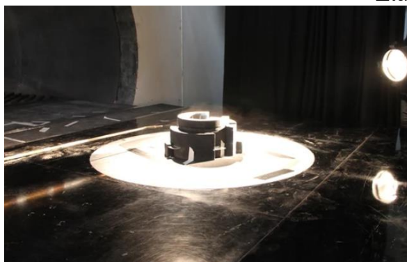
Εικόνα 39 : Δοκιμή της μακέτας του Hardelot στο Soufflerie Eiffel 101
