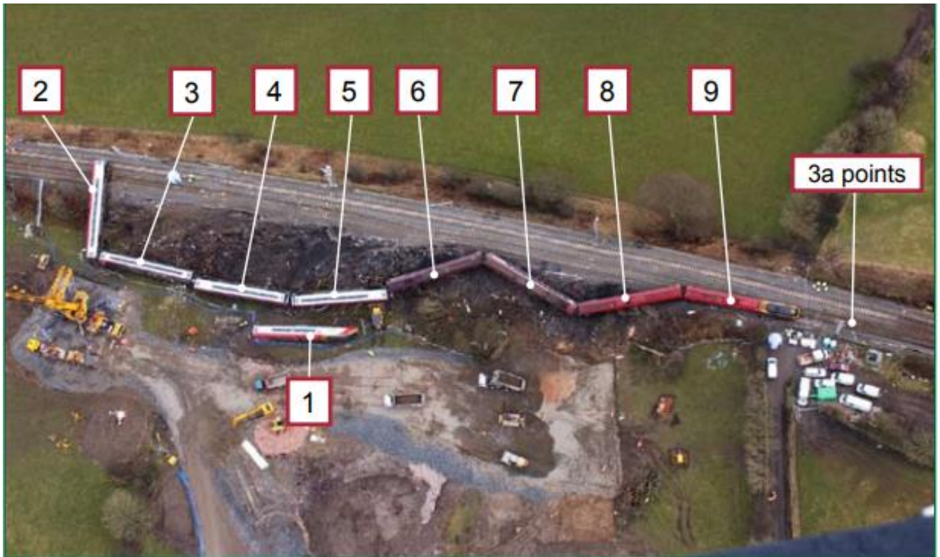
Εικόνα 7. Τελική θέση του εκτροχιασμένου τρένου με αριθμημένα βαγόνια [10]
