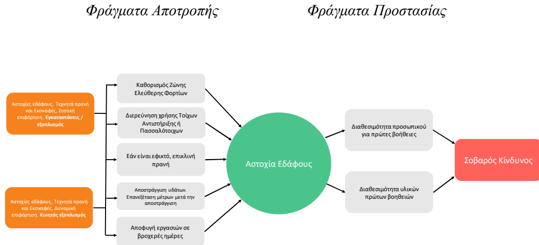
Σχήμα 11: BTA Αστοχία Εδάφους
