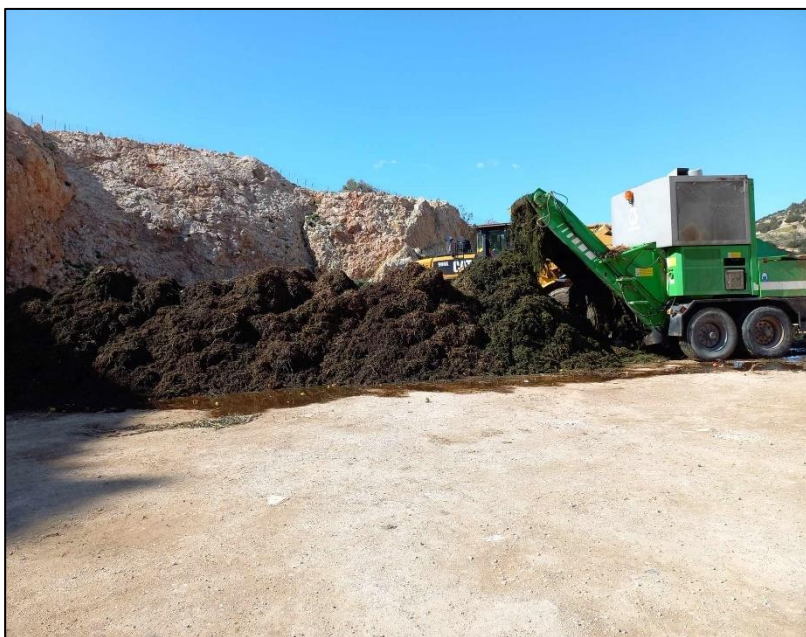
Εικόνα 12 – Έξοδος υλικού από τον σπαστήρα
