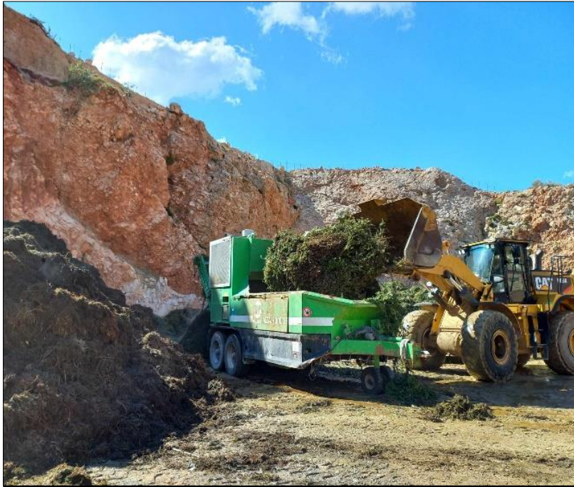
Εικόνα 13- Είσοδος υλικού στον σπαστήρα
