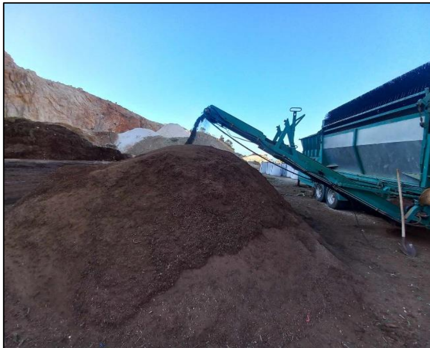
Εικόνα 17 – Έξοδος από υλικού από περιστροφικό κόσκινο
