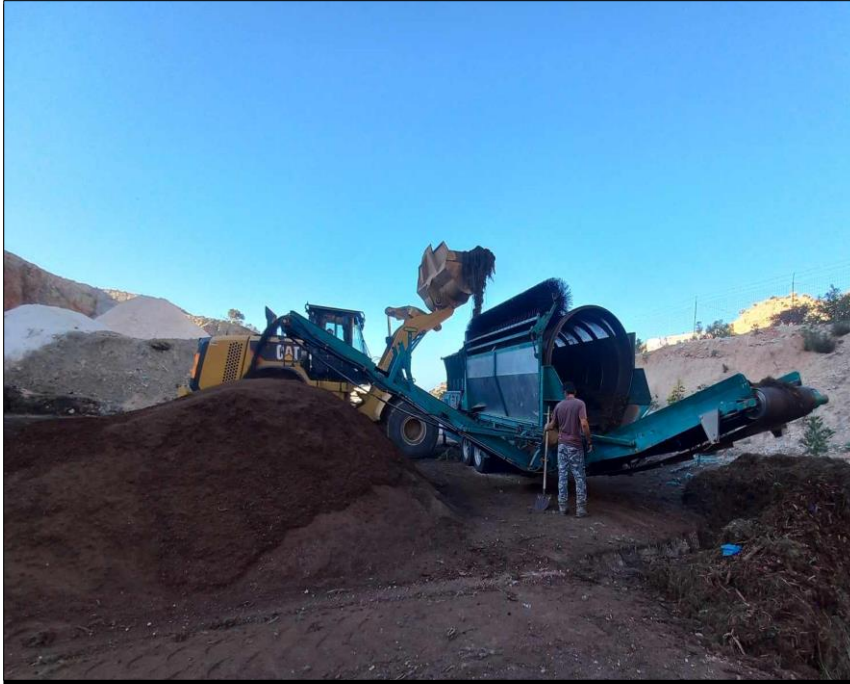
Εικόνα 16- Περιστροφικό κόσκινο
