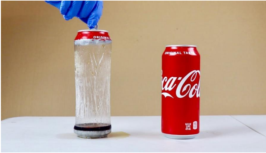
Εικόνα 2.1.1 Πλαστικό πολυμερές εσωτερικά του κουτιού
