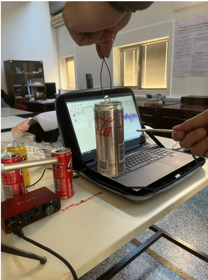
Εικόνα 6.2.6 Μέτρηση από αέρα με την χρήση μικροφώνου
