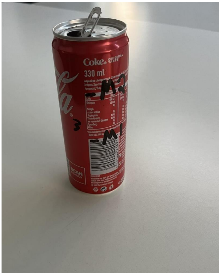
Εικόνα 6.2.2 Σημεία τοποθέτησης πιεζοηλεκτρικού κρυστάλλου (M1-M2)
