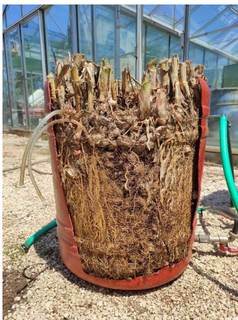
Εικόνα 3.26 Η τομή που έγινε στη μονάδα του πιλοτικού τεχνητού υδροβιότοπου ο οποίος περιείχε χαλίκι.
