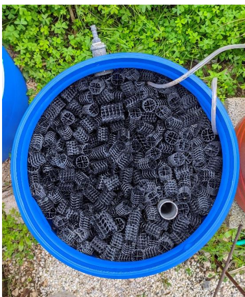
Εικόνα 3.12 Κάτοψη του πιλοτικού τεχνητού υγροβιότοπου που περιείχε ανακυκλωμένο πολυαιθυλένιο υψηλής πυκνότητας και χρησιμοποιήθηκε για έλεγχο.
