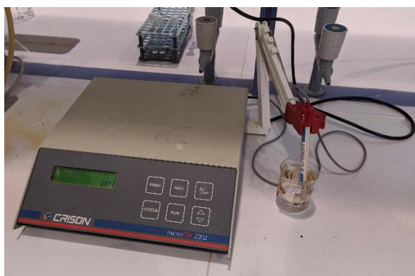
Εικόνα 3.24 Το όργανο μέτρησης ηλεκτρικής αγωγιμότητας που χρησιμοποιήθηκε.
