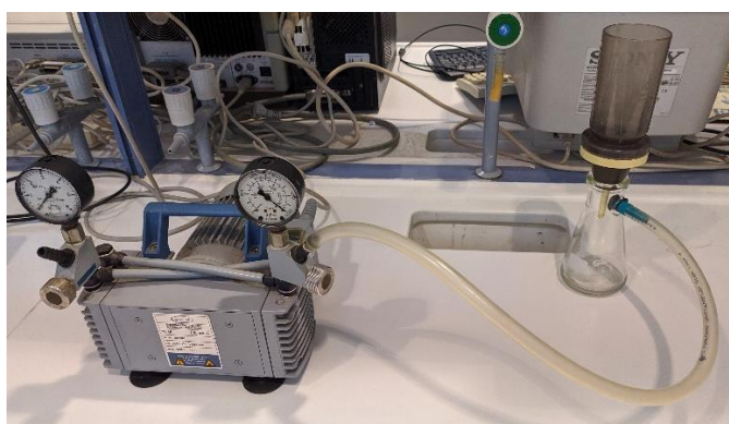
Εικόνα 3.21 Το όργανο που χρησιμοποιήθηκε για την ανάλυση ολικών αιωρούμενων στερεών.
