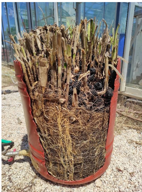
Εικόνα 3.25 Η τομή που έγινε στη μονάδες του πιλοτικού τεχνητού υδροβιότοπου ο οποίος περιείχε ανακυκλωμένο πολυαιθυλένιο υψηλής πυκνότητας.
