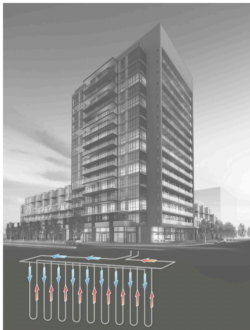
εικόνα 19: ενδεικτική κατασκευή συστήματος γεωθερμίας
