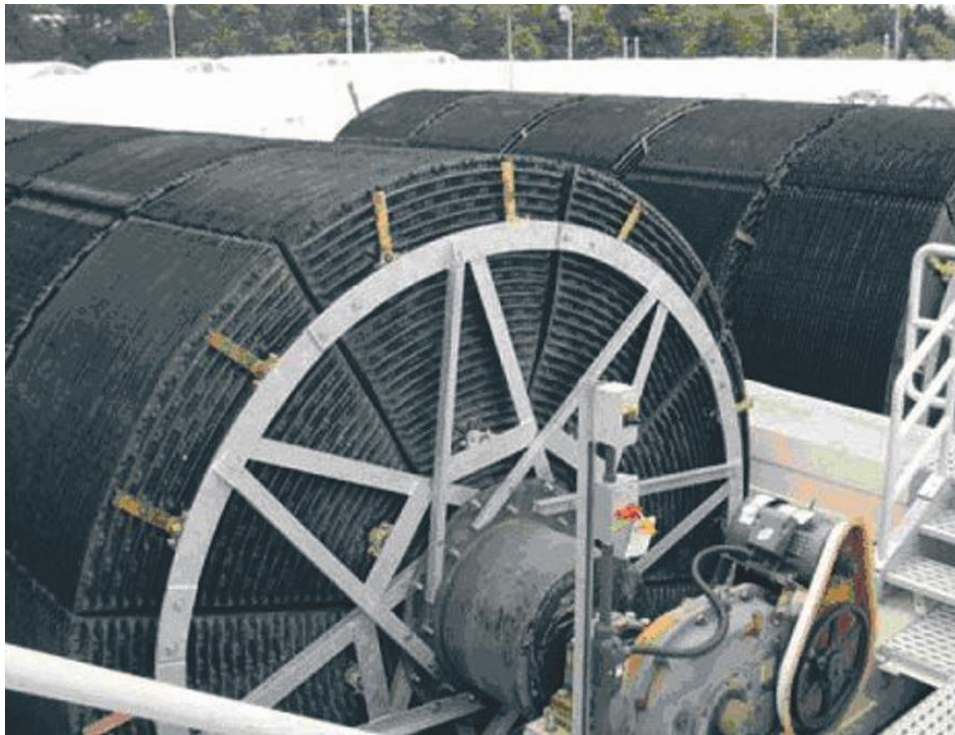
Εικόνα 1.6:Περιστρεφόμενοι βιοδίσκοι (Chen et al., 2020)
