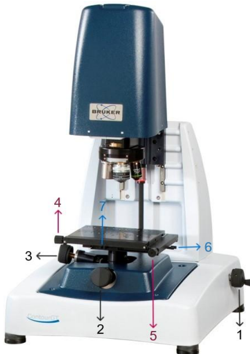
ΟΣχήμα 3.4: Μανιβέλες και μοχλοί του 3D Contour GT-K
