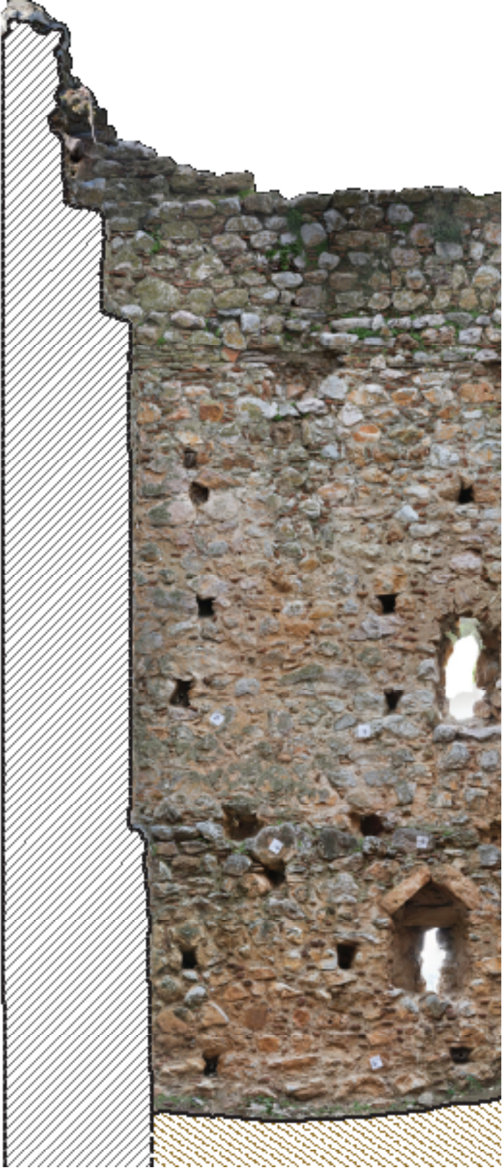
101. Εγκάρσια τομή της λιθοδομής που διακρίνεται η απομείωση του πάχους καθ' ύψος
