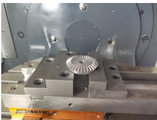
Σχήμα 3.41: Τελικό τεμάχιο κωνικού οδοντωτού τροχού 2.
