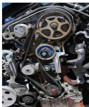
Σχήμα 2.11: Ιμάντες χρονισμού (αριστερά) - Ιμάντες χρονισμού (δεξιά).
