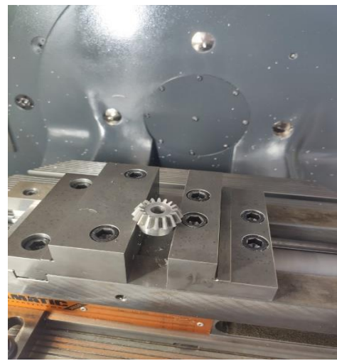
Σχήμα 3.39 : Τελικό τεμάχιο κωνικού οδοντωτού τροχού 1.
