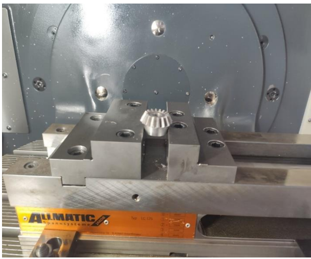
Σχήμα 3.39 : Τελικό τεμάχιο κωνικού οδοντωτού τροχού 1.
