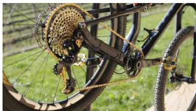
Σχήμα 2.25: Η αλυσοκίνηση ενός ποδηλάτου (αριστερά) - Η αλυσοκίνηση ενός απλού αλυσοτροχού και ενός αλυσοτροχού με αφαλό (δεξιά).
