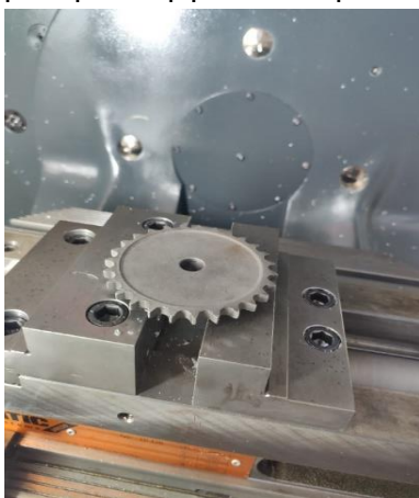
Σχήμα 3.33 : Τελικό τεμάχιο αλυστοροχού.
