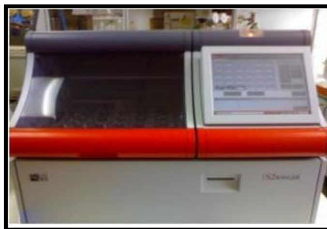
Εικόνα 8: Φασματόμετρο ακτίνων-Χ φθορισμού (X-ray fluorescence spectroscopy) του εργαστηρίου Ανόργανης Γεωχημείας, Οργανικής Γεωχημείας και Οργανικής Πετρογραφίας της Σχολής Μηχανικών Ορυκτών Πόρων [78]
