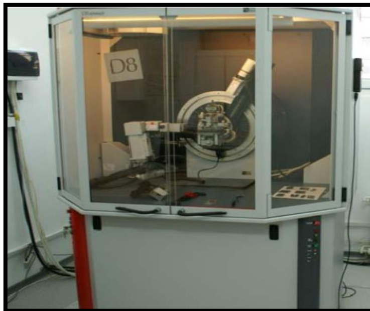
Εικόνα 9: Περιθλασίμετρο ακτίνων-Χ σκόνης (Powder X-ray Diffraction / PXRD) του εργαστήριου Γενικής και Τεχνικής Ορυκτολογίας της Σχολής Μηχανικών Ορυκτών Πόρων [79]
