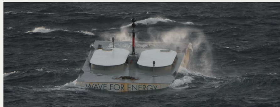
Εικόνα 32: Σύστημα παραγωγής ενέργειας από κύματα θάλασσας (ISWEC)
