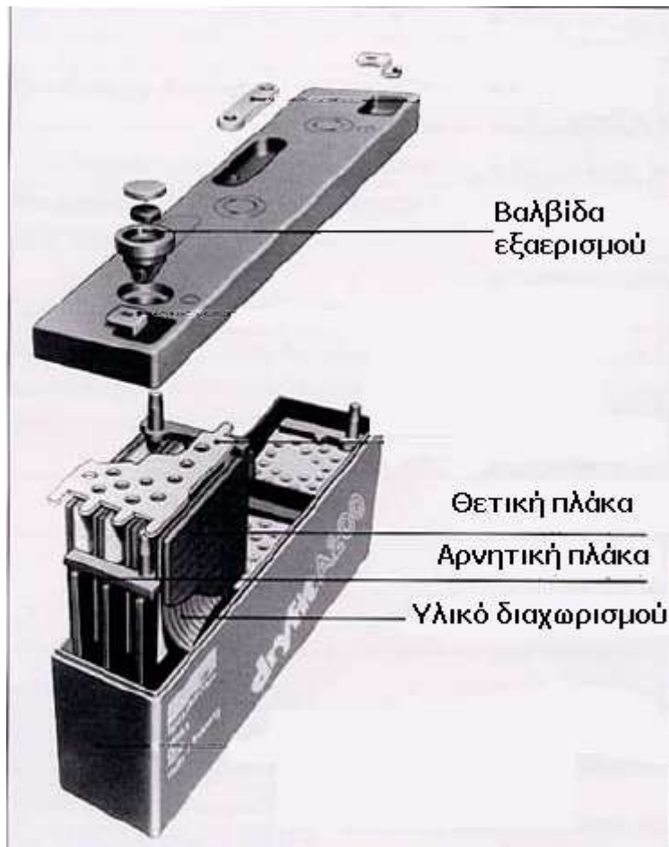
Σχήμα 2.3 Δομή ενός συσσωρευτή μολύβδου οξέος
