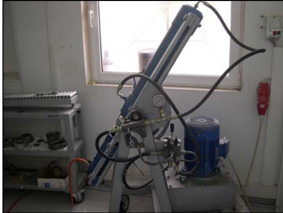
Εικόνα 14: Εμβολικός εξωθητής για την παρασκευή PSZ φίλτρων, του Εργαστηρίου Τεχνολογίας Κεραμικών και Υάλου του Π.Κ..
