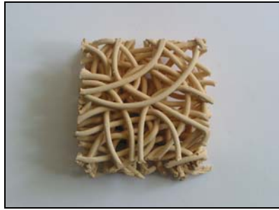
Εικόνα 45 : Μάζες NSZ – μπεντονίτη μετά την έψηση στους 1000°C.
