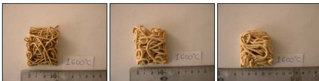
Εικόνα 51 : Μάζες PSZ – μπεντονίτη μετά την έψηση στους 1600 °C.
