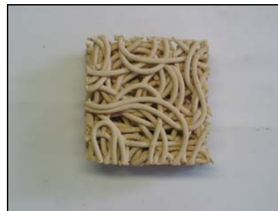
Εικόνα 46 : Μάζες NSZ – μπεντονίτη μετά την έψηση στους 1400°C.
