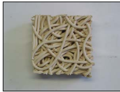
Εικόνα 45 : Μάζες NSZ – μπεντονίτη μετά την έψηση στους 1000°C.
