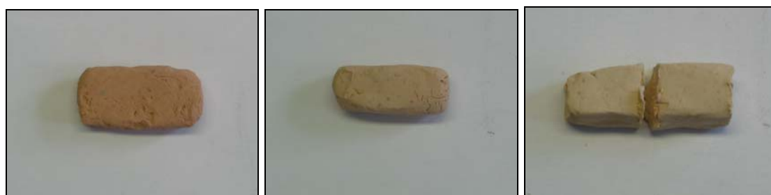
Εικόνα 44 : Μάζες NSZ – μπεντονίτη μετά την έψηση στους 1400°C.
