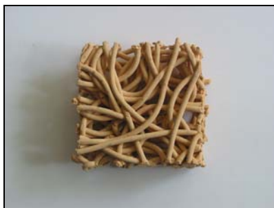
Εικόνα 46 : Μάζες NSZ – μπεντονίτη μετά την έψηση στους 1400°C.
