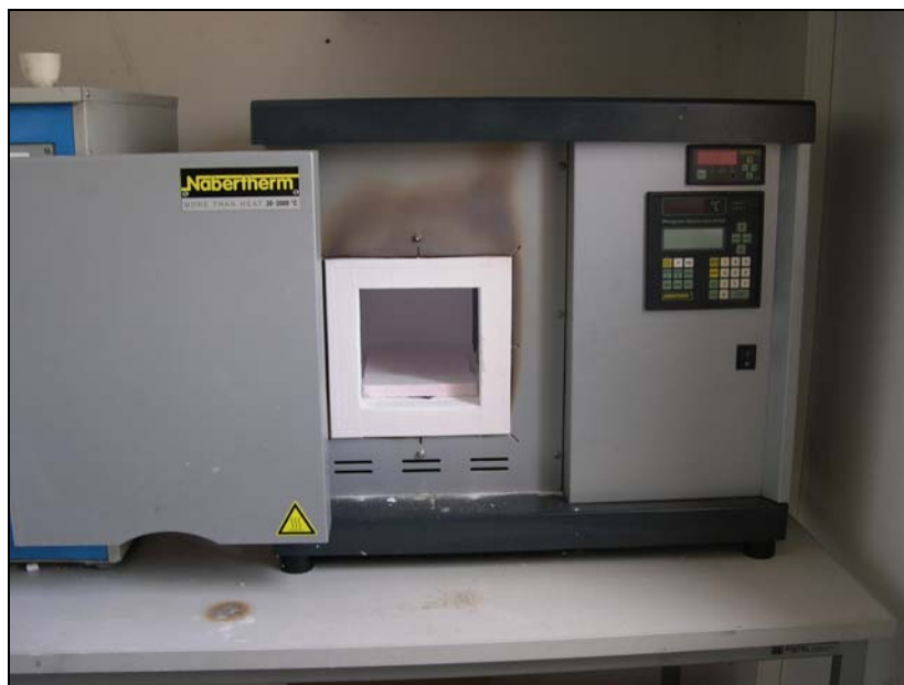
Εικόνα 17: Κλίβανος έψησης δοκιμίων και φίλτρων του Εργαστηρίου Τεχνολογίας Κεραμικών και Υάλου του Π.Κ. .
