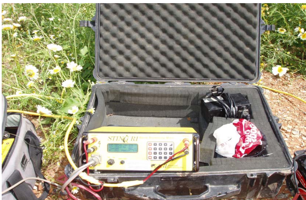
ΕΙΚΟΝΑ 4.5.3.1 Όργανο πραγματοποίησης μετρήσεων ( STING-R1 ).
