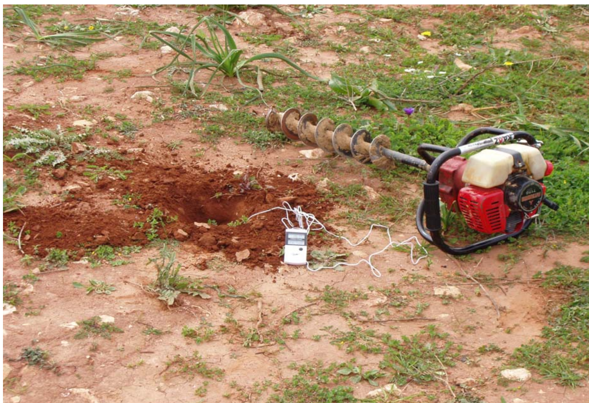
ΕΙΚΟΝΑ 5.3.1 Διαδικασία μέτρησης θερμοκρασίας
