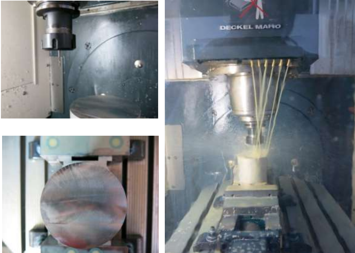
Σχήμα 4.5: Κατεργασία χάραξης με κοπτικό σφαιρικής απόληξης D=2 mm και τελικό αποτέλεσμα
