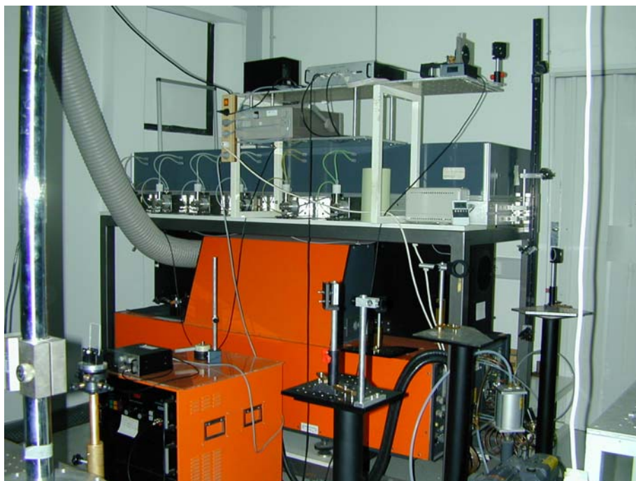
Εικ. 3-1: Υβριδικό σύστημα λέιζερ τύπου KrF/Dye (Ίδρυμα Τεχνολογίας και Έρευνας, ΙΤΕ)
