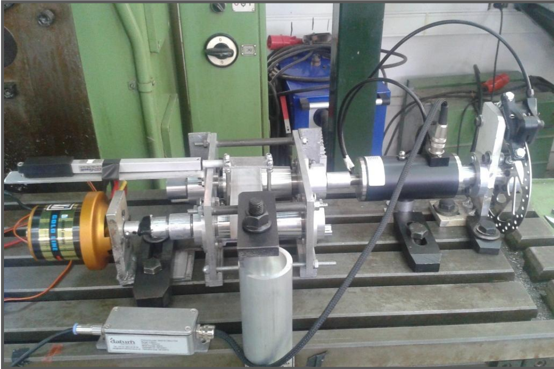
Εικόνα 6.3. Τοποθέτηση μετρητή ροπής στην έξοδο του ESVT.
