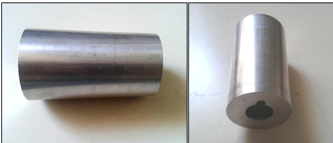
Εικόνα 5.7. Κωνικές τροχαλίες από κράμα αλουμινίου.
