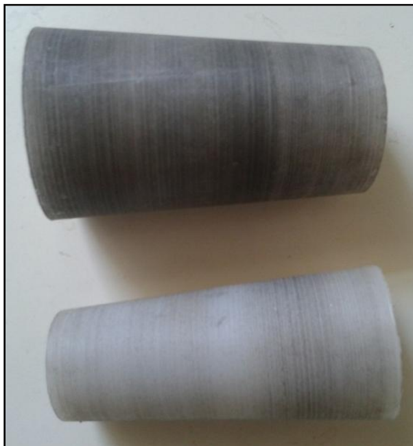
Εικόνα 5.6. Κωνικές τροχαλίες από ERTALON.
