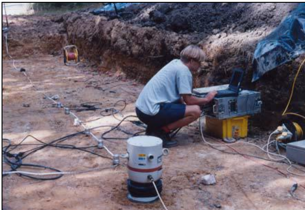
Φωτογραφία 3.1: Μέτρηση της ταχύτητας V_s στο έδαφος
