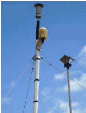
Εικόνα 6.3 Συλλέκτης δειγματοληψίας του αυτόματου οργάνου μέτρησης συγκέντρωσης FH 62 I-R, που ανήκει στο μετεωρολογικό σταθμό του Πολυτεχνείου Κρήτης.
