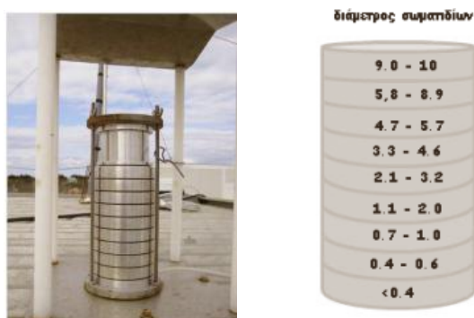
Εικόνα 6.4 A) Andersen Ambient Sampler B) Εύρος τιμών κάθε σταδίου.
