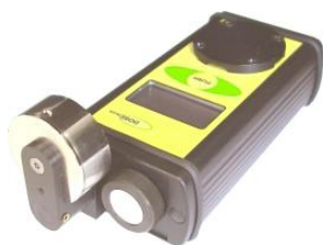
Εικόνα 5.11 Όργανο DOSE man-PRO της εταιρείας SARAD.
