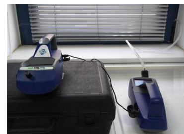
Εικόνα 5.5 Μέτρηση της συγκέντρωσης των αιωρούμενων σωματιδίων με το όργανο DustTrak DRX 8534 σε εσωτερικό χώρο του κτηρίου και μέτρηση στο άμεσο εξωτερικό περιβάλλον, μέσω σωλήνα, με το DustTrak II 8532.
