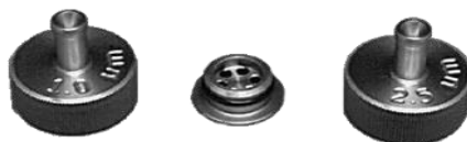
Εικόνα 5.3 Κεφαλές δειγματοληψίας για το όργανο DustTrak 8520 (TSI).
