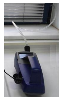
Εικόνα 7.10 Μέτρηση συγκέντρωσης του άμεσου εξωτερικού περιβάλλοντος μέσω σωλήνα με το όργανο DustTrak II 8532.
