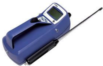
Εικόνα 5.6 Όργανο P-Trak Ultrafine Particle Counter 8525 της TSI (διαστάσεις: 27 x 14 x 14cm).
