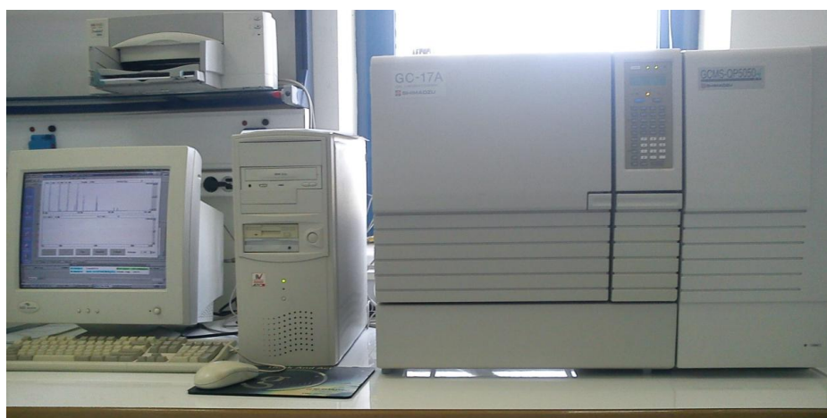
Εικ. 13.6. Φωτογραφία του αναλυτικού οργάνου GC/MS.
