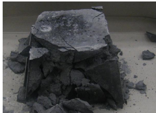
Εικόνα 5.9: Δοκίμιο γεωπολυμερές πριν και μετά τη δοκιμή αντοχής σε μονοαξονική θλίψη
