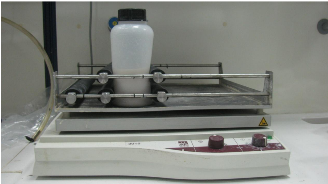
Εικόνα 5.4: Παρασκευή διαλύματος πυριτικού νατρίου
