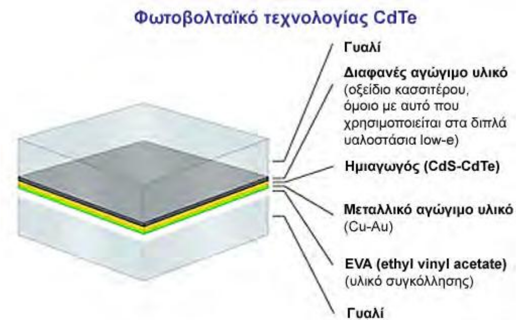
Εικόνα 36 ΑΠΟ ΤΙ ΑΠΟΤΕΛΕΙΤΑΙ ΕΝΑ ΦΩΤΟΒΟΛΤΑΪΚΟ thin film ΤΕΧΝΟΛΟΓΙΑΣ CdTe
