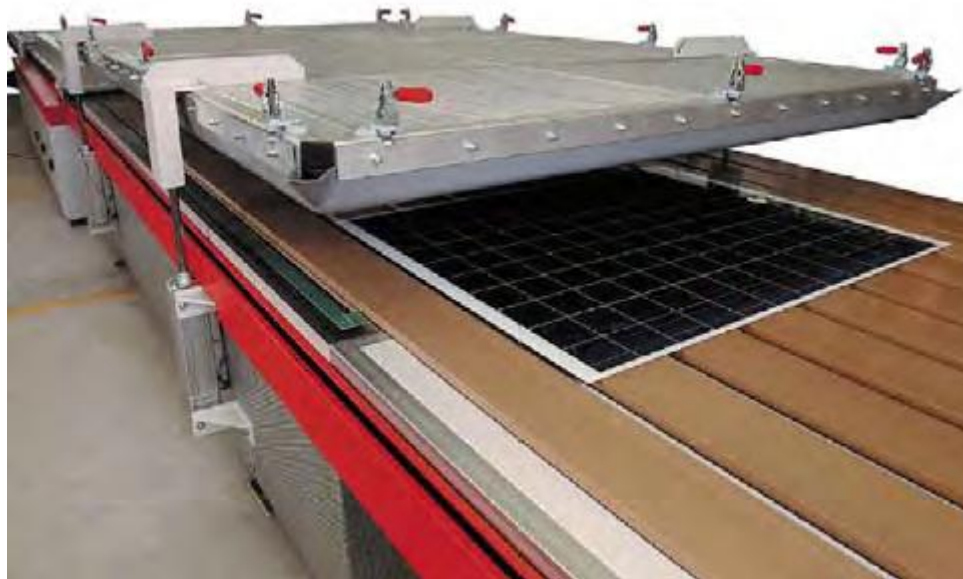
Εικόνα 33 ΣΥΝΑΡΜΟΛΟΓΗΣΗ ΦΩΤΟΒΟΛΤΑΪΚΩΝ ΠΛΑΙΣΙΩΝ (Στάδιο 3)
