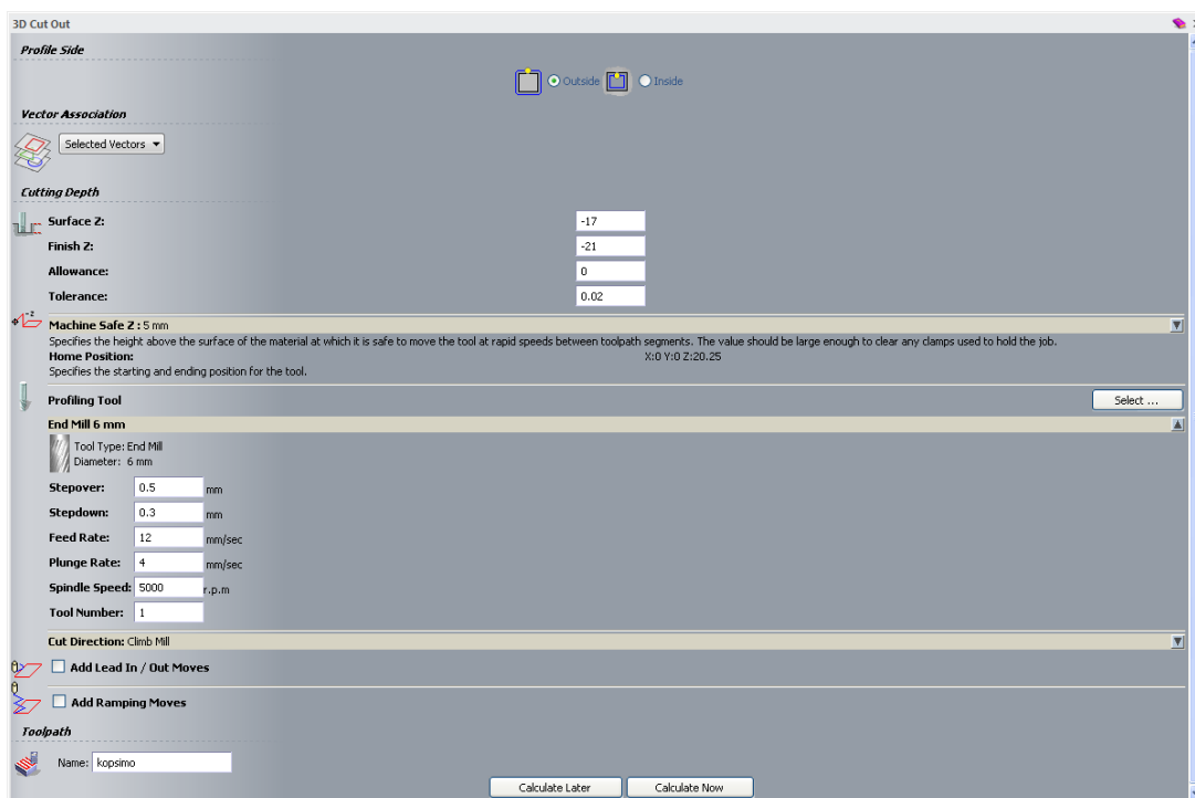
Σχήμα 4.35 : παράθυρο δημιουργίας 3d cut out toolpath και εισαγωγή μεταβλητών κοπής
