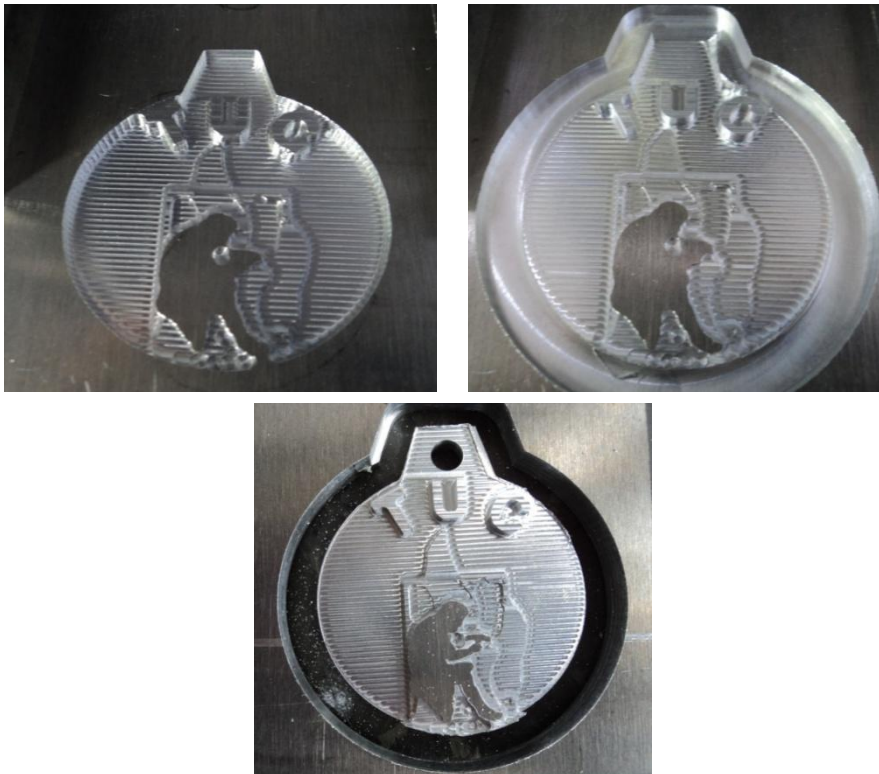
Σχήμα 5.20 :προσομοιωμένες όψεις του ανάγλυφου της α' πλευράς για το 2 ο toolpath – εκχόνδριση με endmill 0.5 mm
