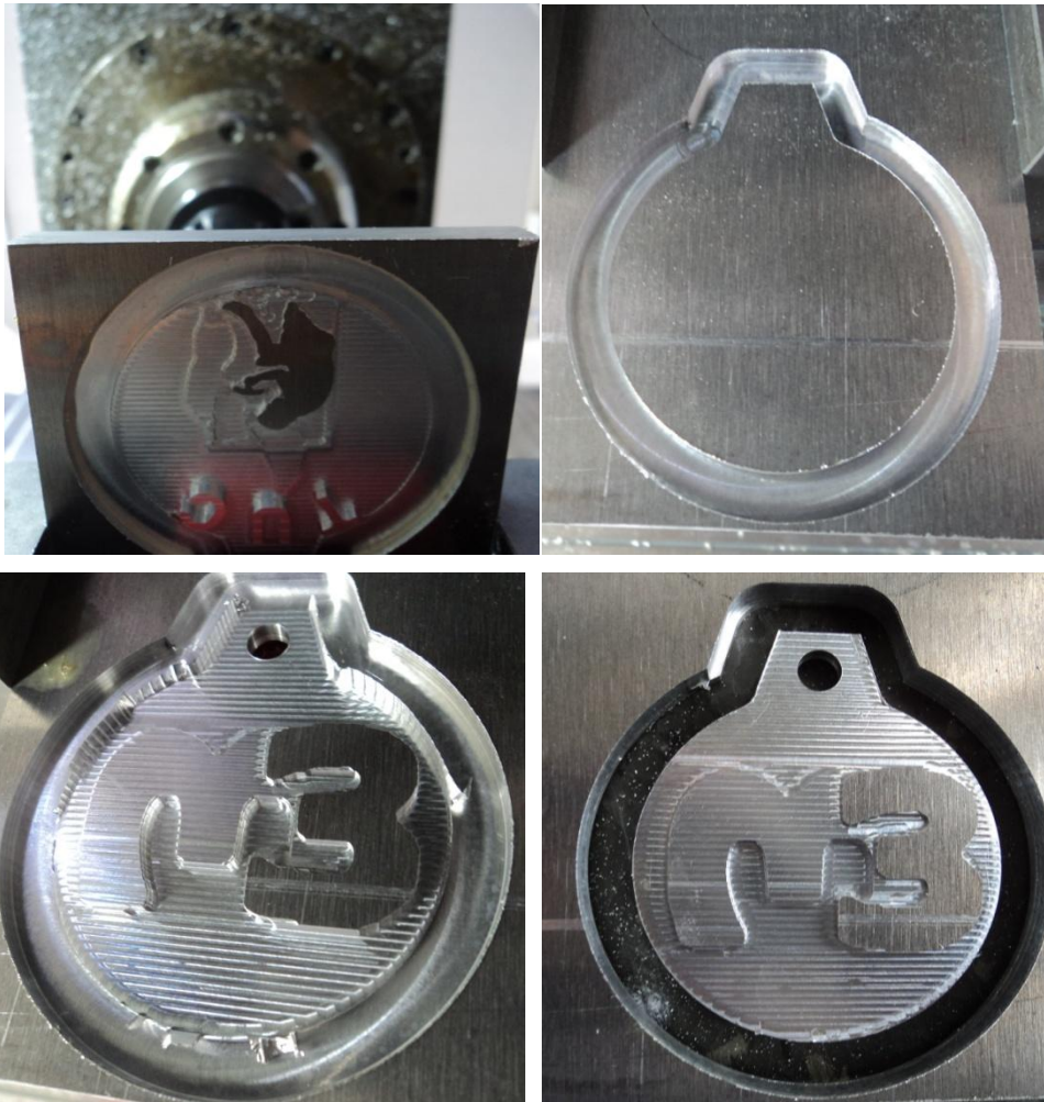
Φωτογραφία 5.25 : β' πλευρά μεταλλίου. Το δοκίμιο αναστράφηκε και επεξεργάστηκε η β' πλευρά. Αρχικά αφαιρέθηκε υλικό περιμετρικά, στη συνέχεια κόπηκε το σχέδιο και φινιρίστηκε. Τέλος έγινε διάτρηση της οπής και αποκόπηκε από το υλικό το μέταλλο
