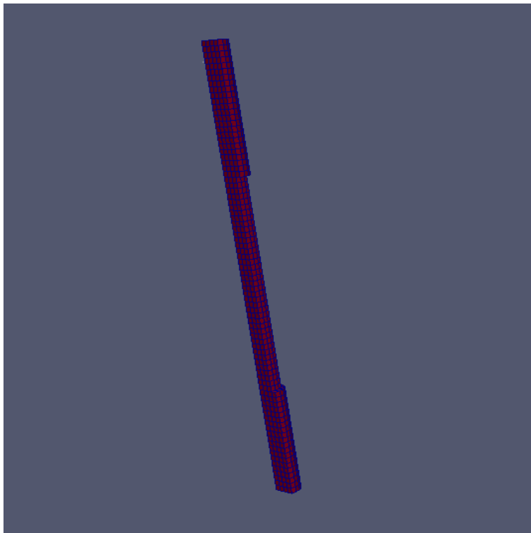
Εικόνα 9: Πάσσαλος με έλλειψη υλικού στις θέσεις 2 και 3 (Αρχείο Fi23)
