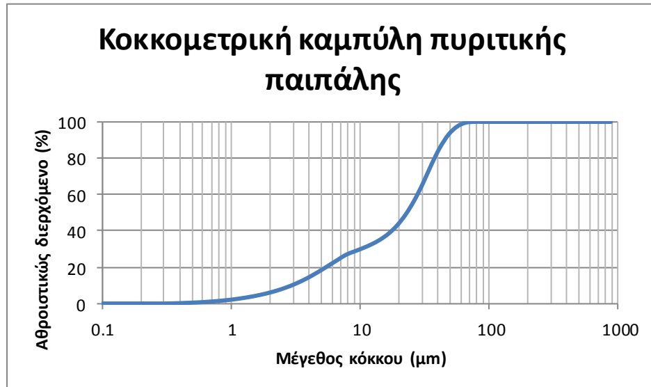
Σχήμα 4.3. Κοκκομετρική καμπύλη πυριτικής παιπάλης.
