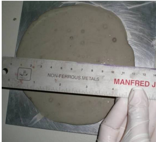
Σχήμα 4.13. Μέτρηση διαμέτρων κώνου εξάπλωσης. ( Πιπερίδη, 2012)
