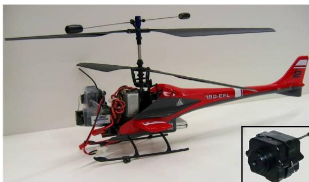
Εικόνα 1.3 . Διάταξη ομοαξονικών στροφείων ίδιου μεγέθους.
