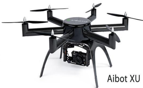
Εικόνα 1.2 . Διάταξη πλαϊνών στροφείων χωρίς κέλυφος.
