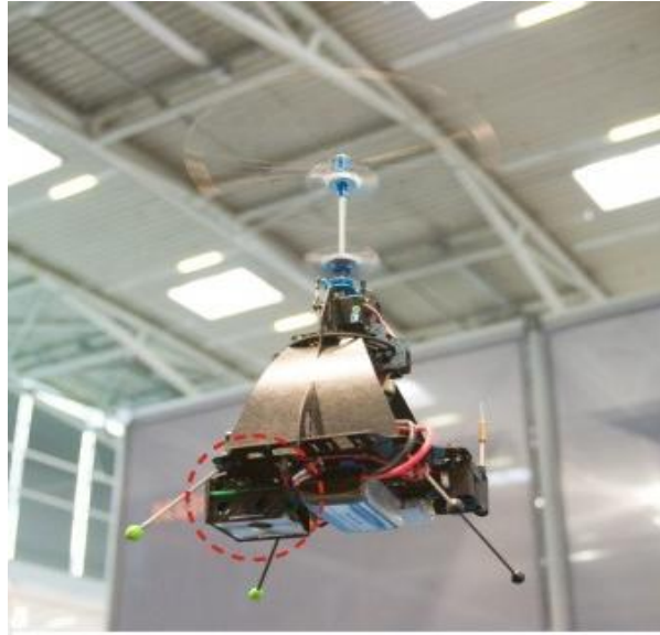
Εικόνα 1.4 . Διάταξη ομοαξονικών στροφείων διαφορετικού μεγέθους.
