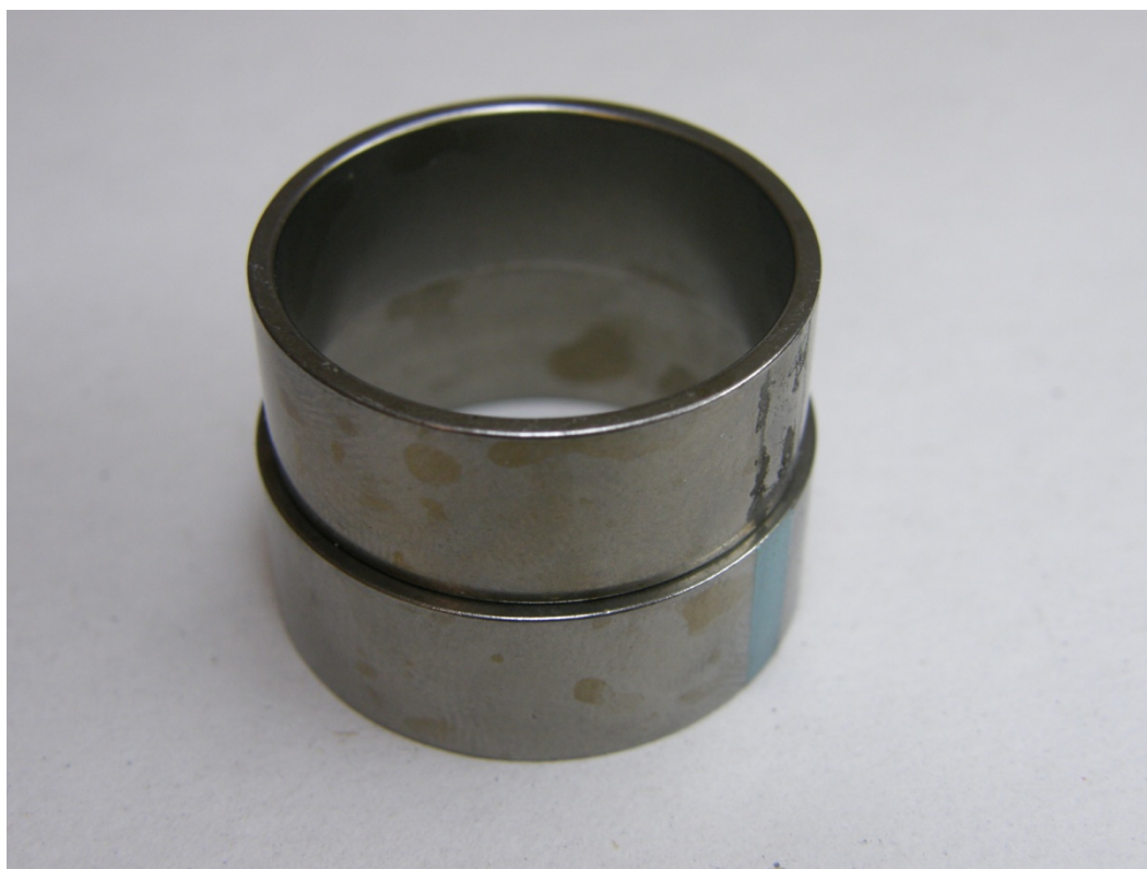
Σύγκριση μεγέθους SMA μετά από θέρμανση και SMA που δεν έχει θερμανθεί.
