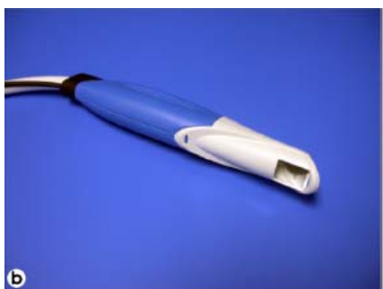
Εικόνα 3.19 QLF εξοπλισμός(α) το QLF φωτεινό κουτί, μια συσκευή χειρός και υγρός οδηγός φωτός (β) μία κοντινή εικόνα από την ενδοστοματική κάμερα
