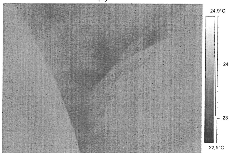
Εικόνα 2.3: Θερμογραφικός έλεγχος στην περιοχή του Διακονικού στο ψηφιδωτό «Άγιος Αβέρκιος» με (α) εικόνα της εξεταζόμενης επιφάνειας και (β) αντίστοιχη θερμική εικόνα, η οποία αποκάλυψε την ύπαρξη υγρασίας, η παρουσία της οποίας ήταν έντονη στη νότια όψη του τόξου περιμετρικά του ψηφιδωτού «Άγιος Αβέρκιος».
