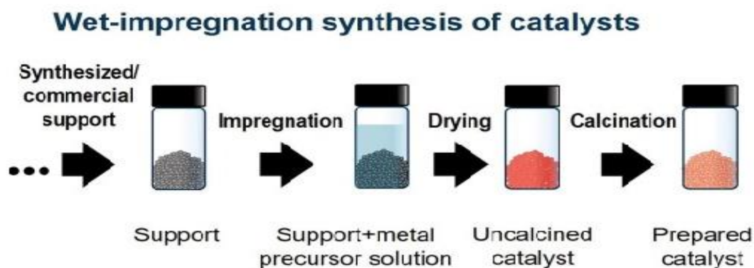
Εικόνα 14 – Μέθοδος υγρού εμποτισμού [58].
