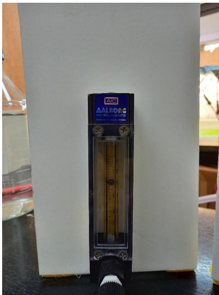
Εικόνα 9. Ροόμετρο παροχής καυσαερίων ρυθμισμένο στα 0,6 L/min.
