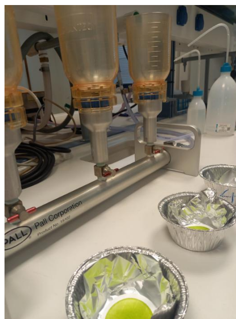
Εικόνα 17. Διήθηση μέσω κενού αέρος του υπερκείμενου υγρού ανά 30 mL.
