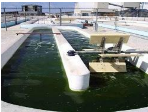
Εικόνα 4. Ανοικτού τύπου καλλιέργεια μικροφυκών.
